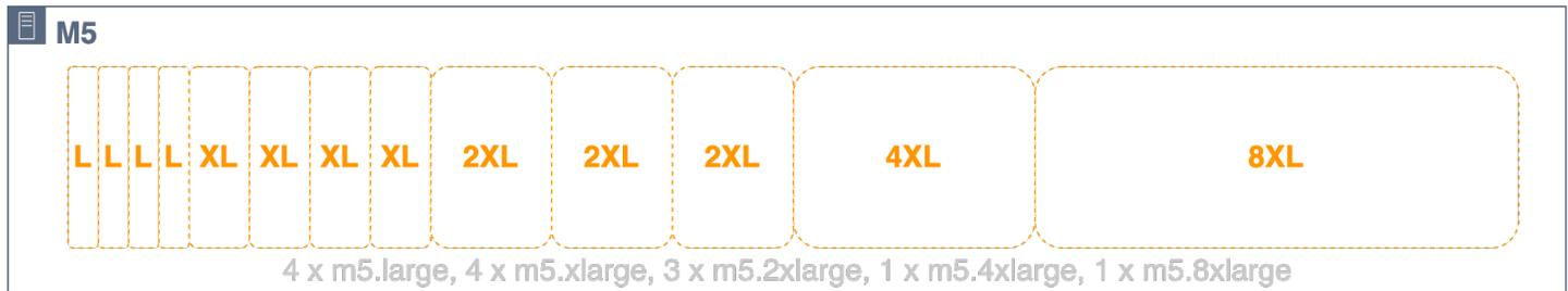
*m5.24xlarge* 主機以異質方式插入 4*m5.large*、4*m5.xlarge*、3*m5.2xlarge*、1 *m5.4xlarge* 和 1 個 *m5.8xlarge* 插槽
