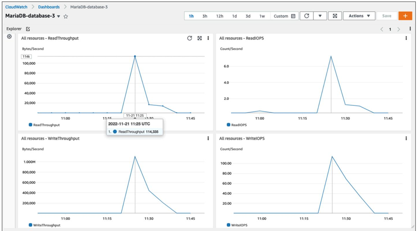
另一組作業系統指標是由 Amazon RDS 的[增強型監控](#)收集。透過提供即時系統指標和作業系統程序資訊，此工具可讓您更深入地了解 Amazon RDS for MariaDB 和 Amazon RDS for MySQL 資料庫執行個體的運作狀態。當您在資料庫執行個體上[啟用增強型監控](#)並設定所需的精細程度時，工具會收集作業系統指標和程序資訊，您可以在 [Amazon RDS 主控台](#)上顯示和分析這些資訊，如下畫面所示。
