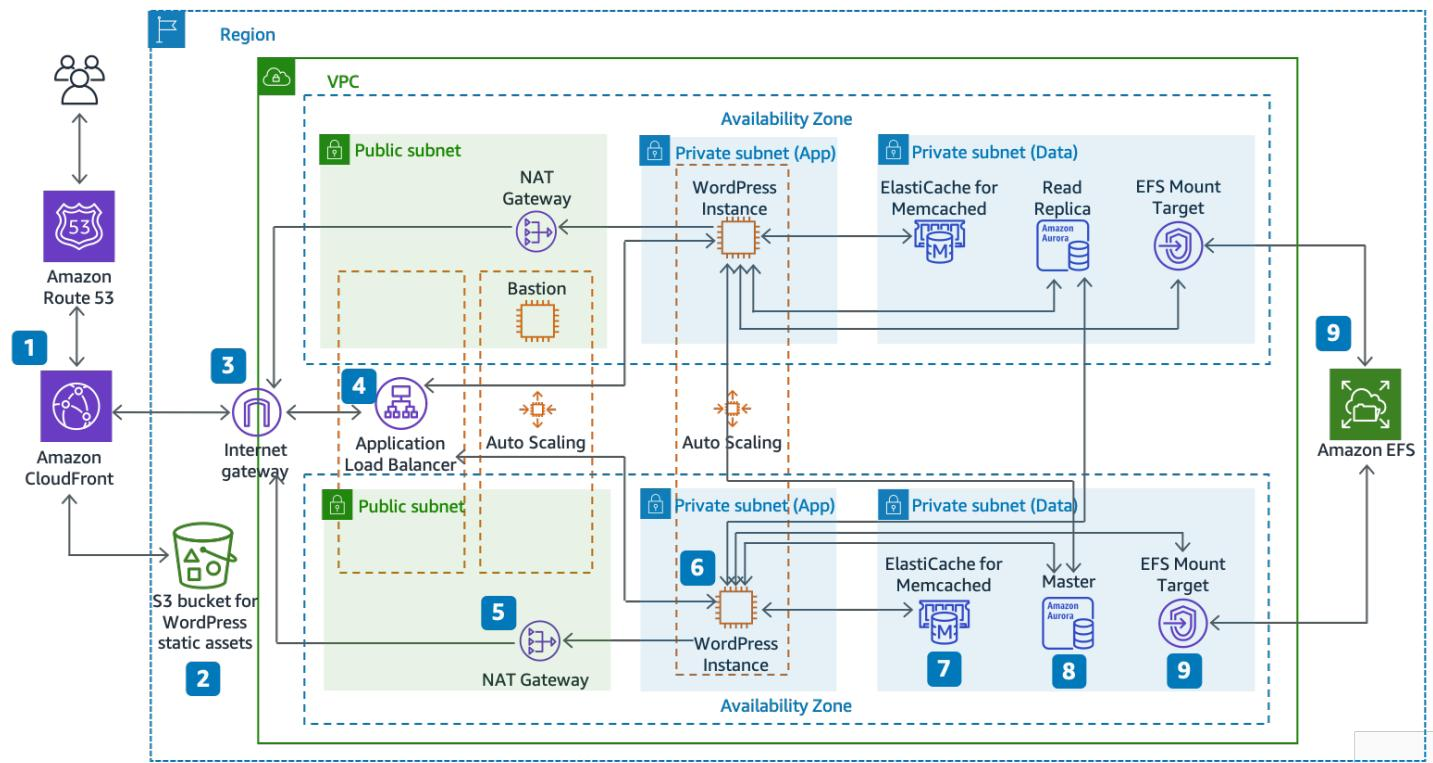
用于托管 WordPress 的参考架构 AWS
