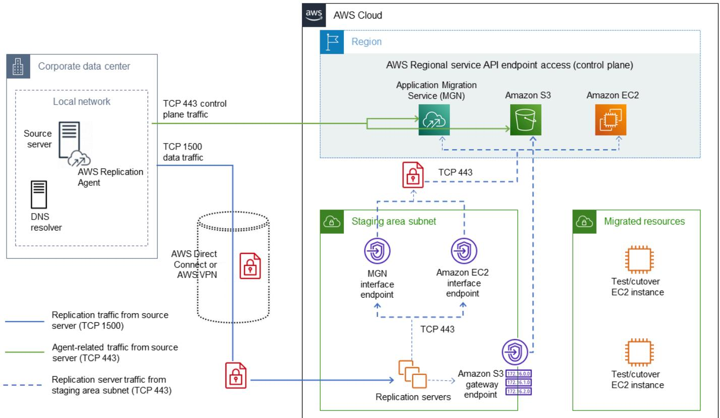
这种架构简化了暂存区域子网的要求，因为来自代理的 HTTPS 通信不通过专用渠道传输。此外，无需为 DNS 流量创建额外的 Amazon S3 接口 VPC 终端节点或 Amazon Route 53 入站解析器终端节点，因为源服务器将使用其传统 DNS 服务器来解析应用程序迁移服务和 Amazon S3 终端节点的标准公有 DNS 名称。
