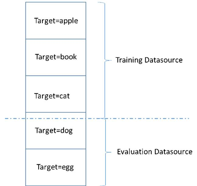
创建数据源时，您可以选择顺序拆分数据源，Amazon ML 使用前 70% 的数据进行训练，使用剩余的 30% 数据进行评估。这是使用 Amazon ML 控制台拆分数据时的默认方法。
