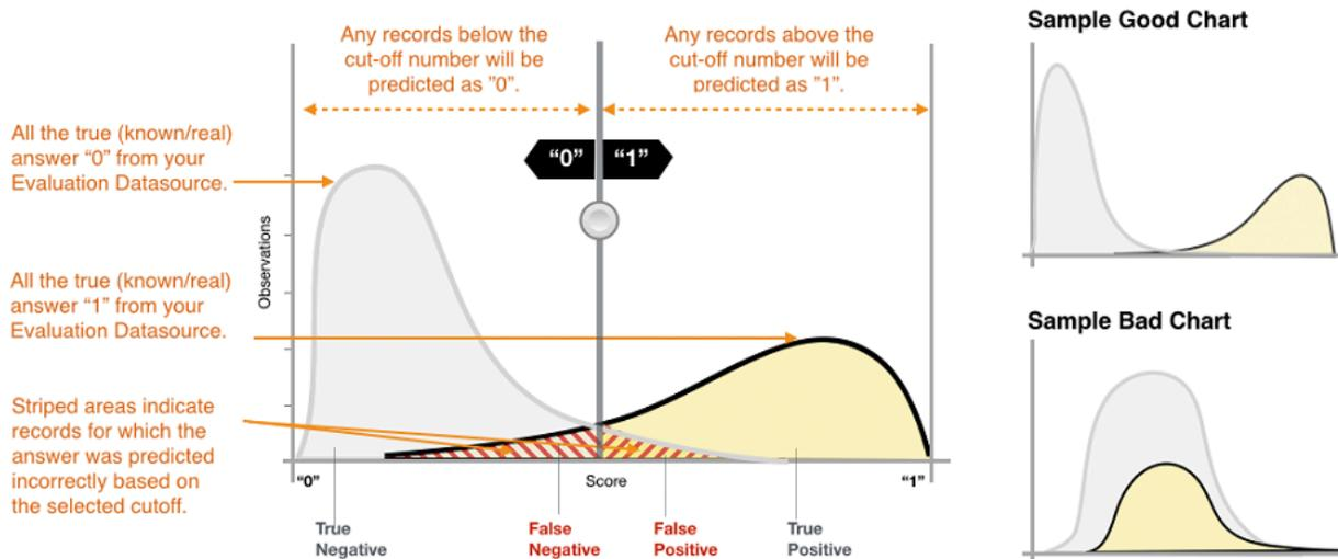
利用可视化内容可以确定属于两种正确预测类型的预测数以及属于两种不正确预测类型的预测数。
