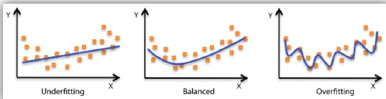
模型在训练数据上性能糟糕时，您的模型欠拟合。这是因为模型无法捕获输入示例（通常称为 X）与目标值（通常称为 Y）之间的关系。当您看到模型在训练数据上表现良好但在评估数据上表现不好时，表示您的模型过度拟合。这是因为模型记住了曾看到的数据，但无法归纳为未看过的示例。
