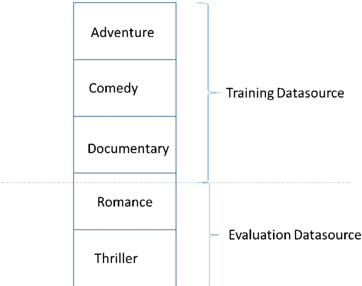
开发高质量 ML 模型中的一个常见陷阱是，评估 ML 模型所用数据与训练所用数据不相似。例如，假设您使用 ML 预测电影的类型，并且您的训练数据包含冒险片、喜剧片和纪录片类型的电影。但是，您的评估数据只包含来自爱情片和惊悚片类型的数据。这种情况下，ML 模型未学习任何关于爱情片和惊悚片类型的信息，评估过程未评估模型的冒险片、喜剧片和纪录片模式学习模式效果如何。因此，类型信息无用，ML 模型的所有类型预测质量受损。模型和评估太过不同（描述性统计信息具有极大的差别）而无用。当输入数据按数据集中的一列排序然后按顺序拆分时，会出现这种情况。
