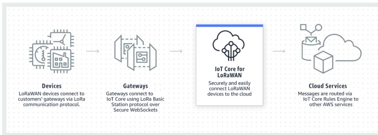
LoRaWAN 设备通过 LoRaWAN 网关与 AWS IoT Core 进行通信。适用于 LoRaWAN 的 AWS IoT Core 可管理 AWS IoT Core 用于管理 LoRaWAN 网关和设备并与其进行通信所需的服务和设备策略。适用于 LoRaWAN 的 AWS IoT Core 还管理描述将设备数据发送到其他服务的 AWS IoT 规则的目标。
