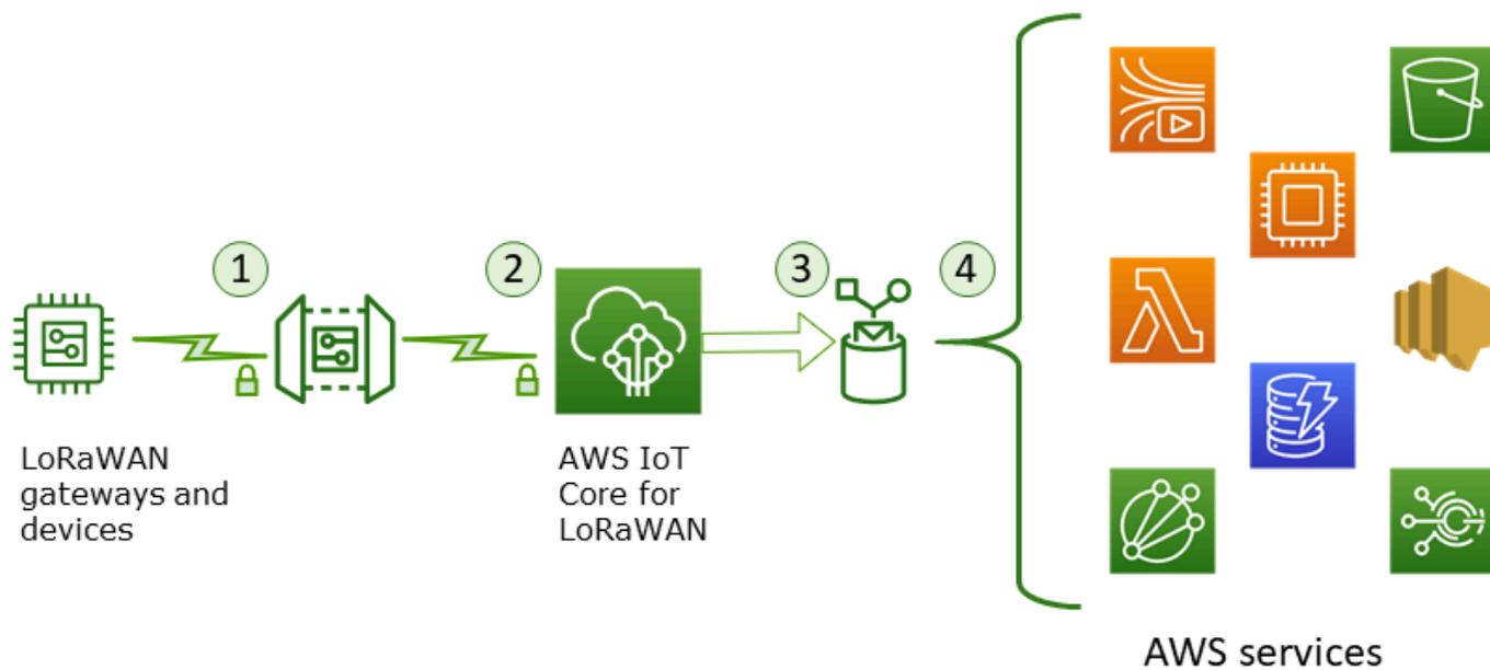
当无线设备开始发送上行链路数据时，适用于 LoRaWAN 的 AWS IoT Core 将无线元数据信息与负载打包，然后将其发送到 AWS 应用程序。
