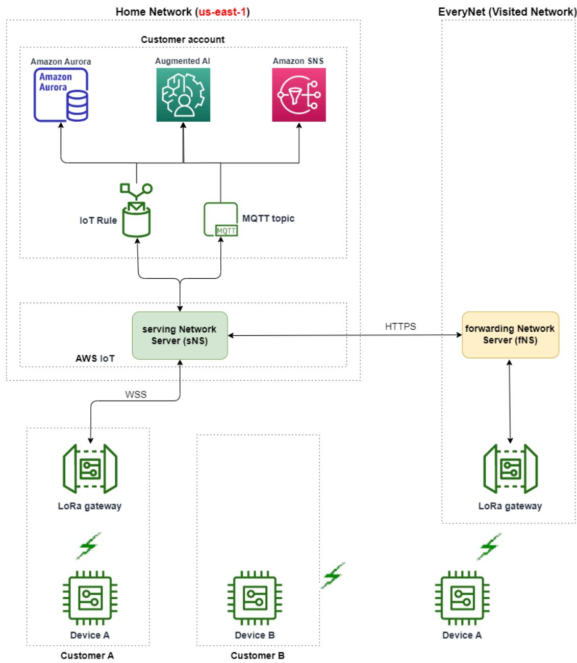
适用于 LoRaWAN 的 AWS IoT Core 根据 [LoRa Alliance LoRaWAN 漫游中心技术建议](#) 使用漫游中心功能。漫游中心为 Everynet 提供一个端点，用于路由从终端设备接收到的流量。在这种情况下，Everynet 充当转发网络服务器（fNS），以转发从设备收到的流量。它使用由 LoRa Alliance 规范定义的 HTTP RESTful API。
