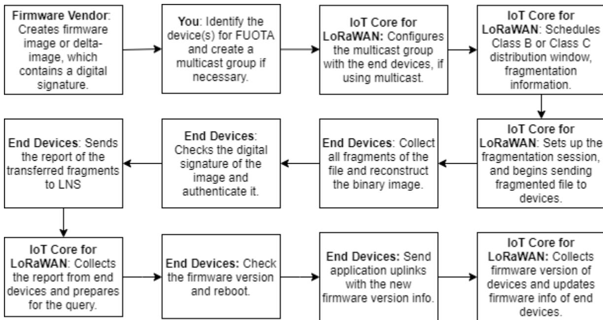
要对设备执行 FUOTA，请首先创建数字签名固件映像，然后配置要添加到 FUOTA 任务中的设备和多播组。启动 FUOTA 会话后，您的终端设备会收集所有碎片，从碎片中重建映像，将状态报告至适用于 LoRaWAN 的 AWS IoT Core，然后应用新的固件映像。
