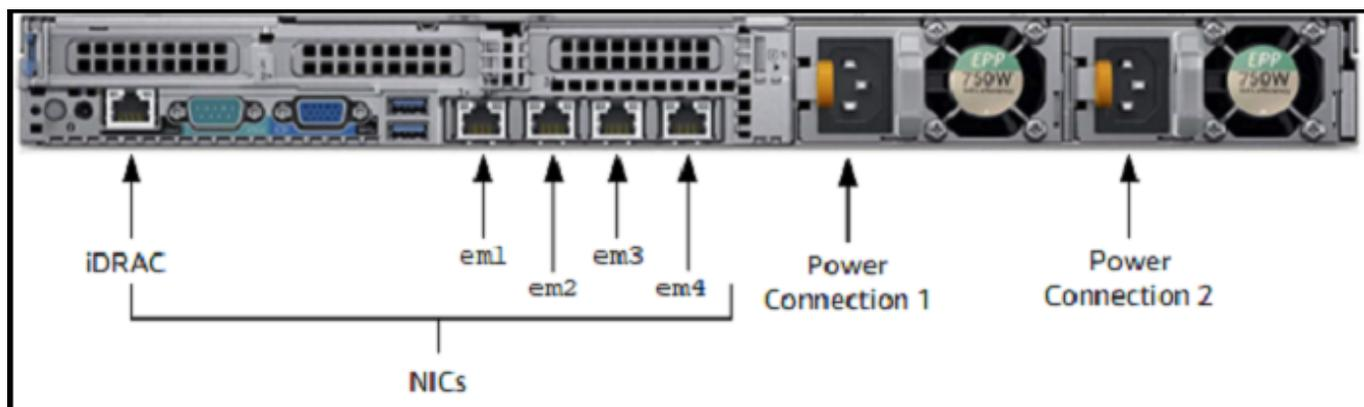
2. 将以太网电缆插入 em1 端口以提供始终开启的 Internet 连接。em1 端口是后部的四个物理网络端口的第一个（从左至右）。
