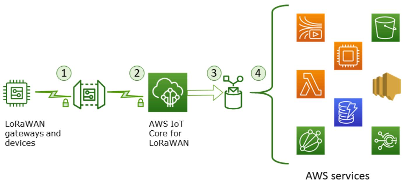
1. O dispositivo sem fio LoRaWAN criptografa as mensagens binárias usando o modo AES128 CTR antes de transmiti-las.
