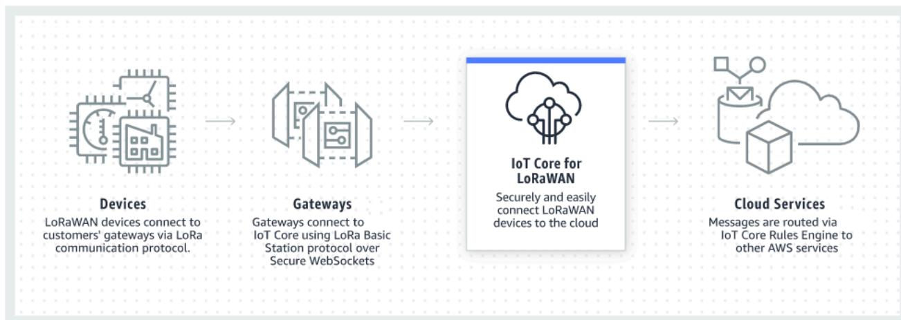
Os dispositivos LoRaWAN se comunicam com o AWS IoT Core por meio de gateways LoRaWAN. O AWS IoT Core for LoRaWAN gerencia as políticas de serviços e de dispositivos exigidas pelo AWS IoT Core para gerenciar e se comunicar com gateways e dispositivos LoRaWAN. O AWS IoT Core for LoRaWAN também gerencia os destinos que descrevem as regras do AWS IoT que enviam dados de dispositivos a outros serviços.
