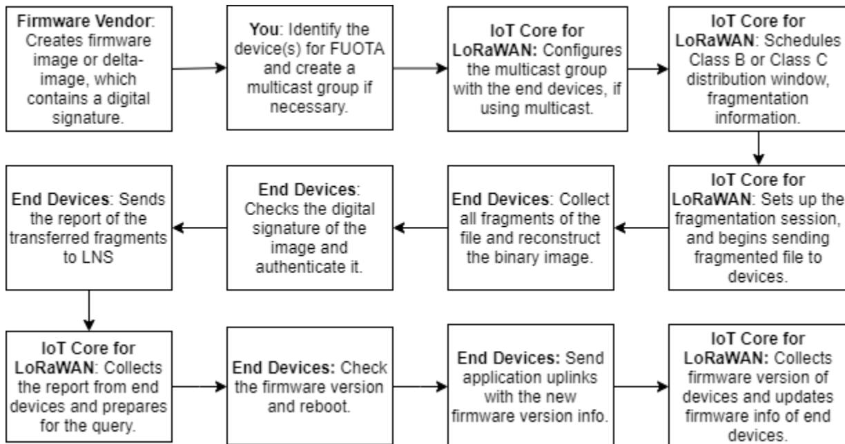
Para executar o FUOTA nos dispositivos, primeiramente crie uma imagem de firmware assinada digitalmente e configure os dispositivos e grupos multicast a serem adicionados à tarefa FUOTA. Após iniciar uma sessão FUOTA, os dispositivos finais coletam todos os fragmentos, reconstruem a imagem a partir dos fragmentos, reportam o status ao AWS IoT Core for LoRaWAN e aplicam a nova imagem de firmware.
