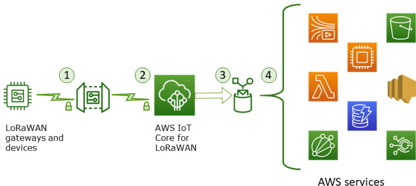
Quando o dispositivo sem fio começa a enviar dados de uplink, o AWS IoT Core for LoRaWAN agrupa as informações de metadados sem fio com a carga e as envia para seus aplicativos da AWS.
