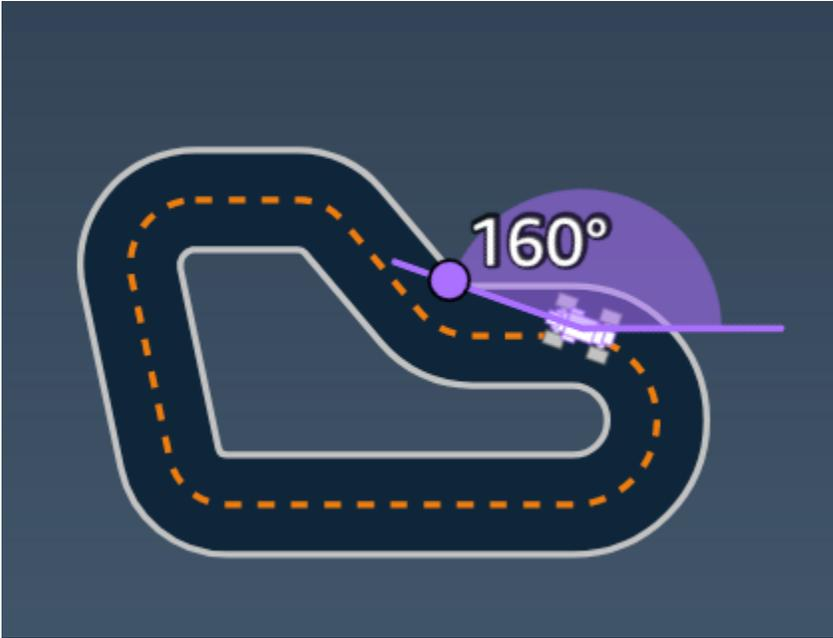
Exemplo: Uma função de recompensa usando o parâmetro *heading*
