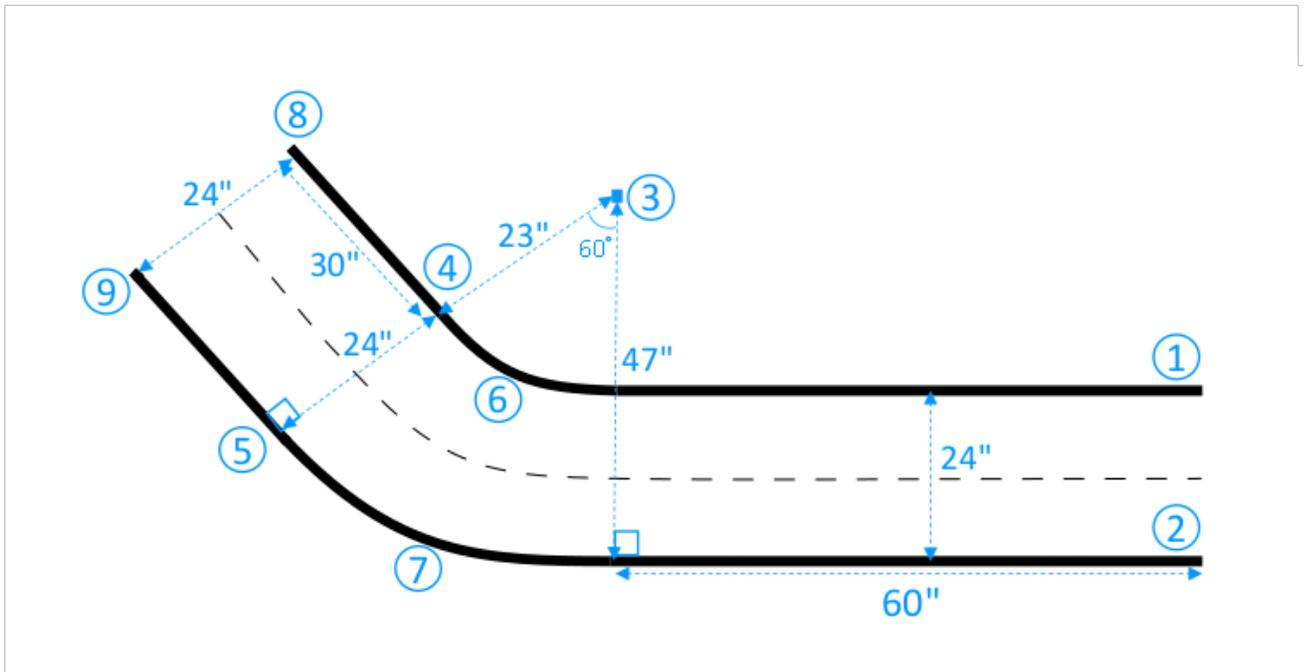
Assumimos que o segundo segmento de pista reto tem 76 cm (30 polegadas) de comprimento e 61 cm (24 polegadas) de largura. Você pode ajustar o comprimento e a largura para se adequar ao seu espaço, desde que os requisitos dimensionais sejam atendidos e as dimensões sejam consistentes com os outros segmentos da pista.
