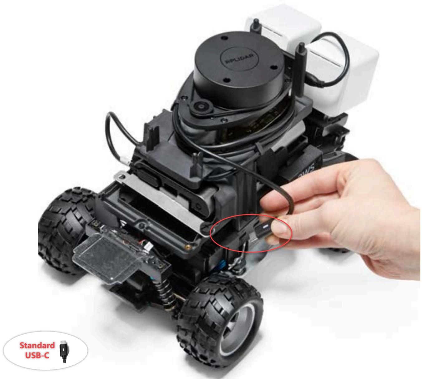
5. Coloque a concha Evo em seu DeepRacer veículo AWS e aperte-a com pinos para testar o ajuste. Quando a carroceria se encaixa corretamente, o sensor LiDAR fica totalmente visível através do recorte no invólucro e você tem acesso aos orifícios na parte superior dos suportes. Remova a carroceria e ajuste o cabo conforme necessário.
