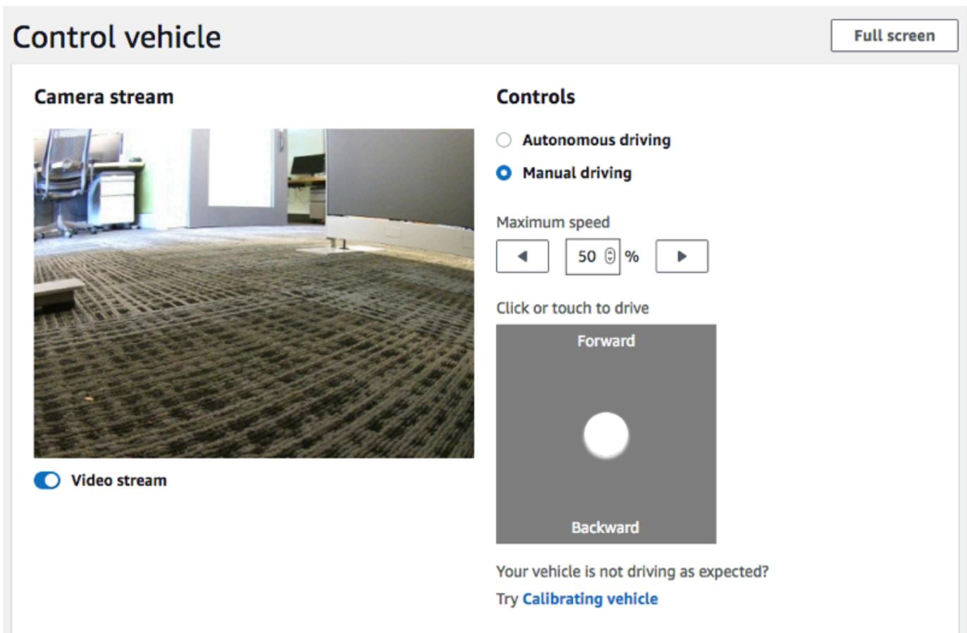
3. Em Clicar ou tocar para dirigir, clique ou toque em uma posição dentro do bloco de condução para conduzir o veículo. As imagens capturadas na câmera frontal do veículo são exibidas no vídeo no Streaming da câmera.
