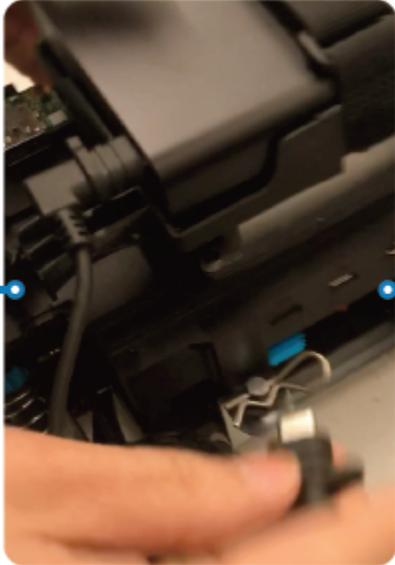
2. Conecte o cabo de alimentação CA e o cabo USB-C no adaptador de alimentação do módulo de computação (A). Conecte o cabo de alimentação em uma tomada (C) e conecte o cabo USB-C na porta de alimentação do módulo de computação do veículo (B).
