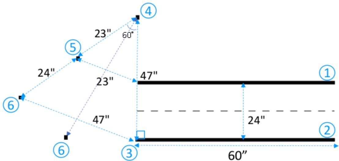
Para fazer uma curva de 60 graus na pista, use o triângulo equilátero (3-4-6) para determinar a localização dos dois endpoints (5) e (6) para o segmento curvado da pista. Para curvas com ângulos diferentes, use um transferidor (ou um aplicativo de transferidor) para localizar as duas extremidades finais (5) e (6) do segmento curvado da pista. Variações no raio de curva são aceitáveis, desde que o requisito de raio mínimo de curva da Etapa 2 seja atendido.
