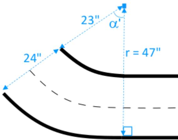
O raio de curva mínimo ( $r_{\min}$ ) depende do ângulo de curva da pista ( $\alpha$ ) em uma curva e deve estar em conformidade com os seguintes limites:
