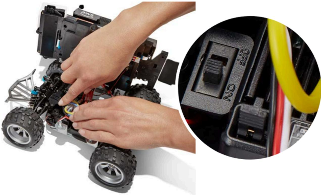
3. Se não ouvir dois bipes ao ligar a bateria do carro, verifique se a bateria está totalmente carregada. Encaixe o cabo de conexão branco da bateria do veículo no adaptador de carga, que pode ser diferenciado do adaptador do módulo de computação pelas luzes indicadoras de LED vermelhas e verdes. Encaixe o adaptador ao cabo de carga e conecte-o a uma tomada. Quando as luzes vermelhas e verdes do adaptador de carga da bateria do veículo estiverem acesas, a bateria ainda precisará ser carregada.
