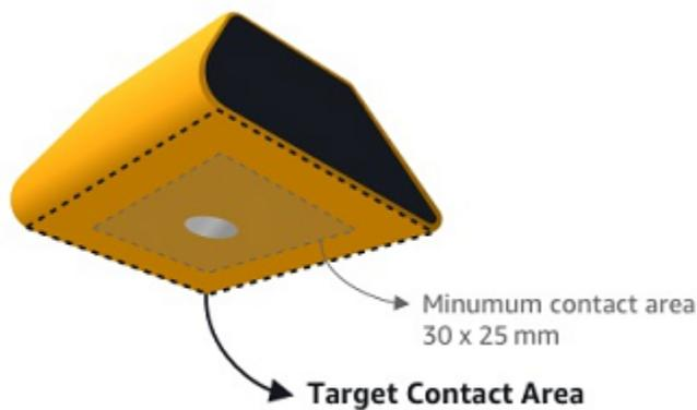
Conecte o sensor com um adesivo industrial. Recomendamos um epóxi do tipo cianoacrilato. Para obter informações adicionais sobre como conectar o sensor ao seu ativo, consulte [Como colocar sensores](#) no Guia do usuário do Amazon Monitron.
