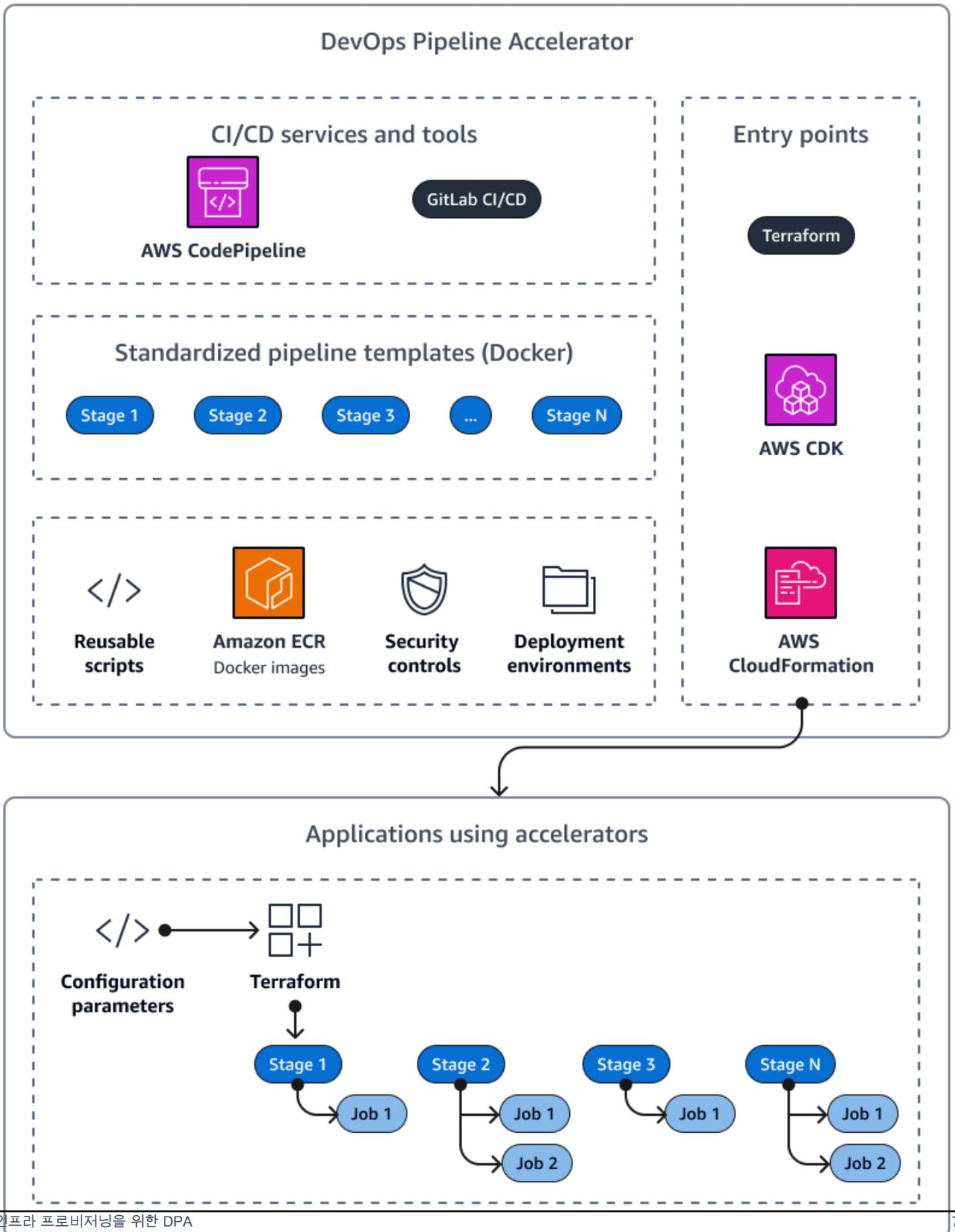
다음 이미지는 Terraform 진입점을 사용하는 Terraform 기반 애플리케이션의 참조 파이프라인을 보여줍니다. 배포 후 단계가 끝나면 코드는 스테이징 및 프로덕션 환경에 배포하기 위한 릴리스 파이프라인에 들어갑니다.
