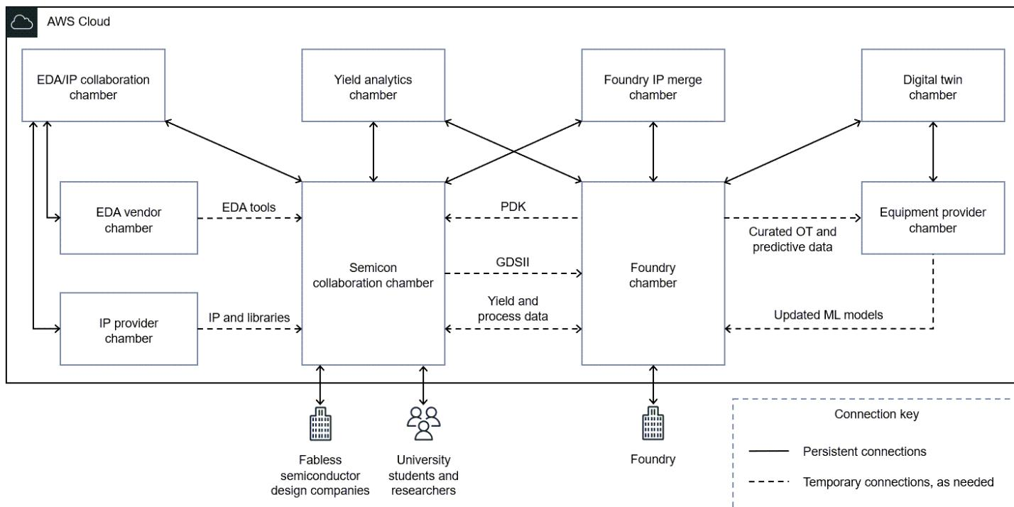
次の図は、コラボレーションチャamberのリファレンスアーキテクチャです。このアーキテクチャは、AWS 上でコラボレーションチャamberを設計および構築する際のリファレンスとして使用できます。この図に示されている AWS のセキュリティ、ガバナンス、およびモニタリングサービスは、IP を保護するためにチャamberを保護するのに役立ちます。これらのサービスの詳細については、このガイドの「[半導体開発環境向けの AWS セキュリティサービス](#)」を参照してください。
