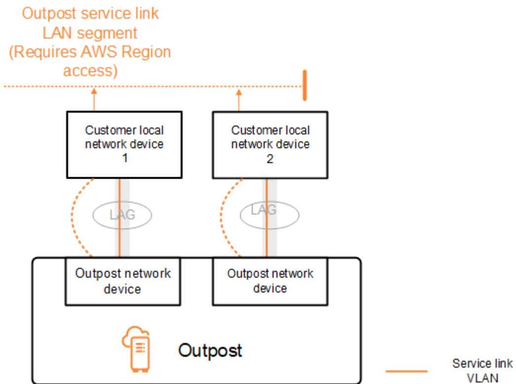
Outpost は、以下のプロセスを使用してサービスリンク VLAN 上で外部 BGP ピアリングセッションを確立します。
