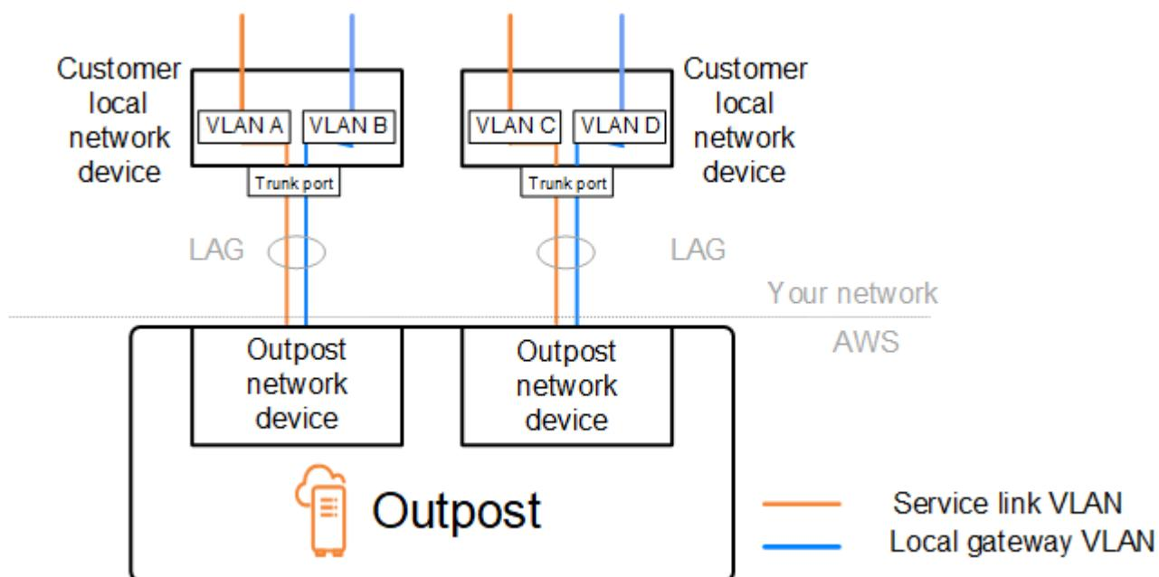
設置中および運用中に Outpost をオンプレミスネットワークと統合するには、Outpost ネットワークデバイスとカスタマーのローカルネットワークデバイス間で使用する VLAN を割り当てる必要があります。インストール AWS する前に、この情報を [提供する必要があります。詳細については、「the section called “ネットワーク準備チェックリスト”」を参照してください。](#)
