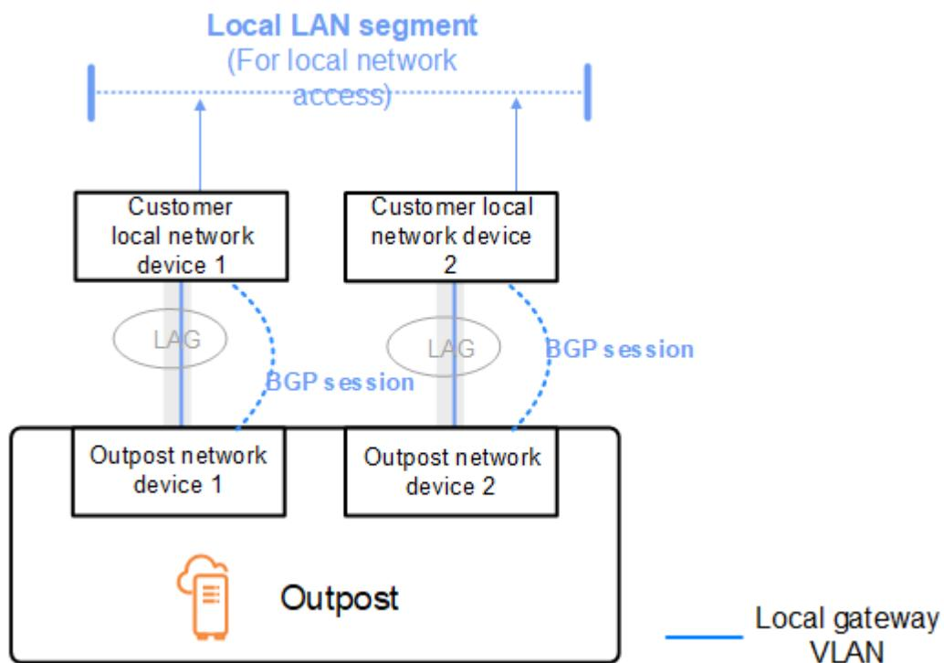
お客様のネットワーク機器は、BGP 属性を変更せずに Outpost から BGP アドバタイズを受信し、BGP マルチパス/ロードバランシングを有効にして最適なインバウンドトラフィックフローを可能にすることをお勧めします。AS-Path のプリペンドは、メンテナンスが必要な場合にトラフィックを OND から離れるようにするために、ローカルゲートウェイのプレフィックスに使用されます。お客様のネットワークは、4 の AS-Path length のルートよりも、1 の AS-Path length の Outposts からのルートを優先する必要があります。
