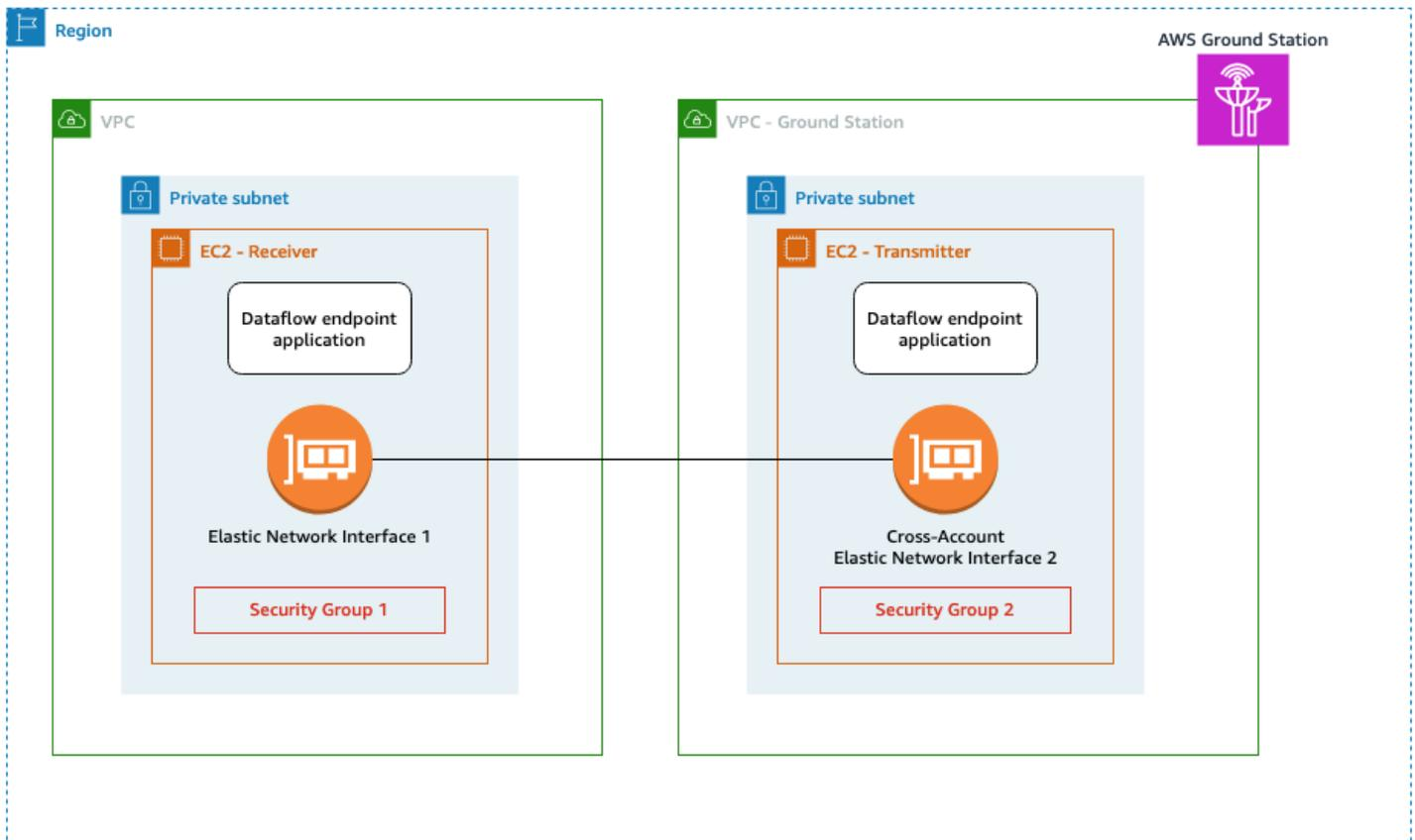
衛星データは、アンテナに近接するデータフローエンドポイントアプリケーションインスタンスに提供されます。その後、データは、 が所有する VPC からクロスアカウント [Amazon EC2 Elastic](#)
