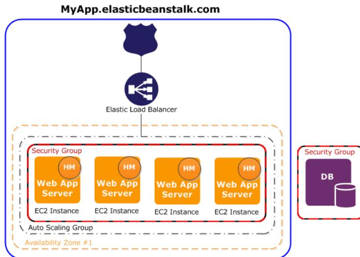
環境はアプリケーションの中心です。この図では、環境は最上位の実線内に示されています。環境を作成すると、Elastic Beanstalk はアプリケーションの実行に必要なリソースをプロビジョニングします。環境用に作成された AWS リソースには、1 つの Elastic Load Balancer (図の ELB)、Auto Scaling グループ、および 1 つ以上の Amazon Elastic Compute Cloud (Amazon EC2) インスタンスが含まれます。
