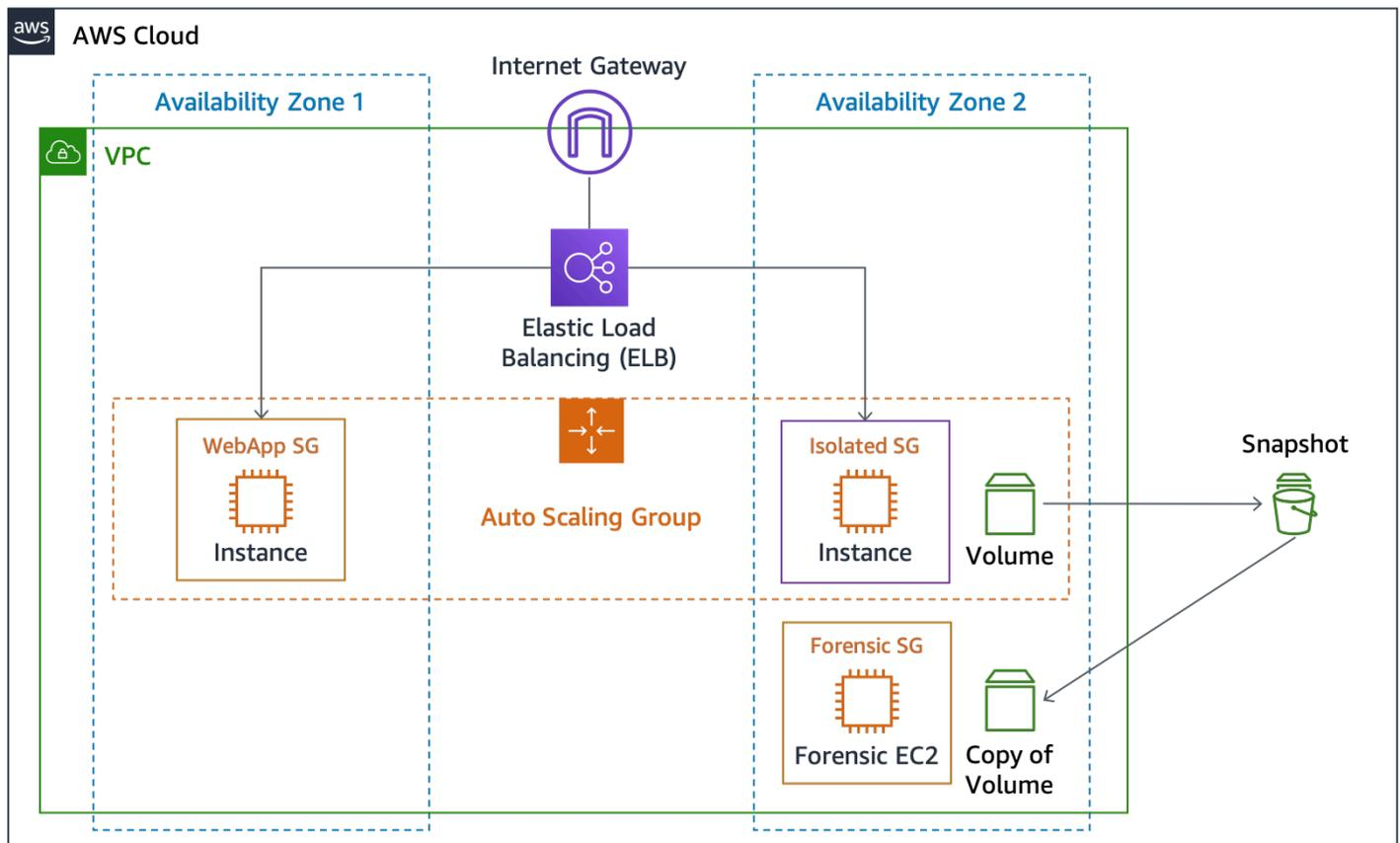
Figura 6: Isolamento e snapshot delle istanze EC2
