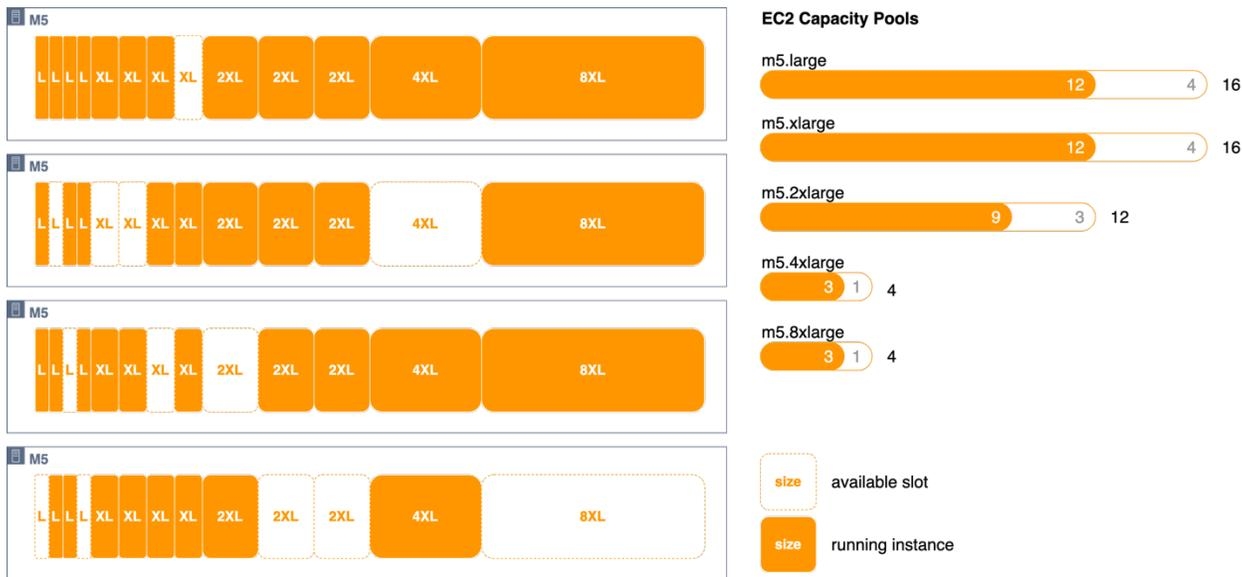
Visualizzazione degli slot EC2 host, delle istanze in esecuzione e dei pool di slot
