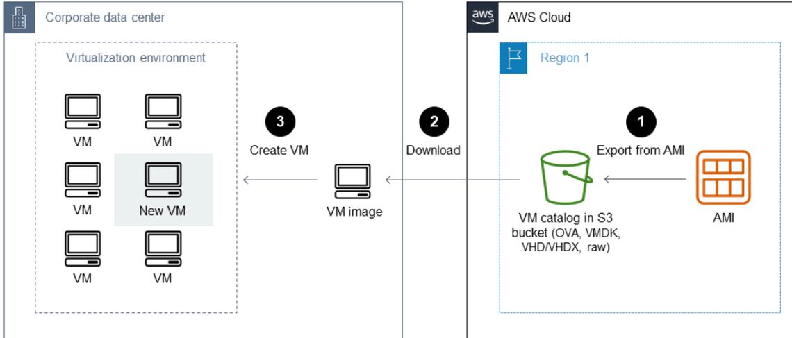
Il diagramma seguente mostra l'architettura delle opzioni di migrazione necessarie per consentire l'esportazione da un'istanza.
