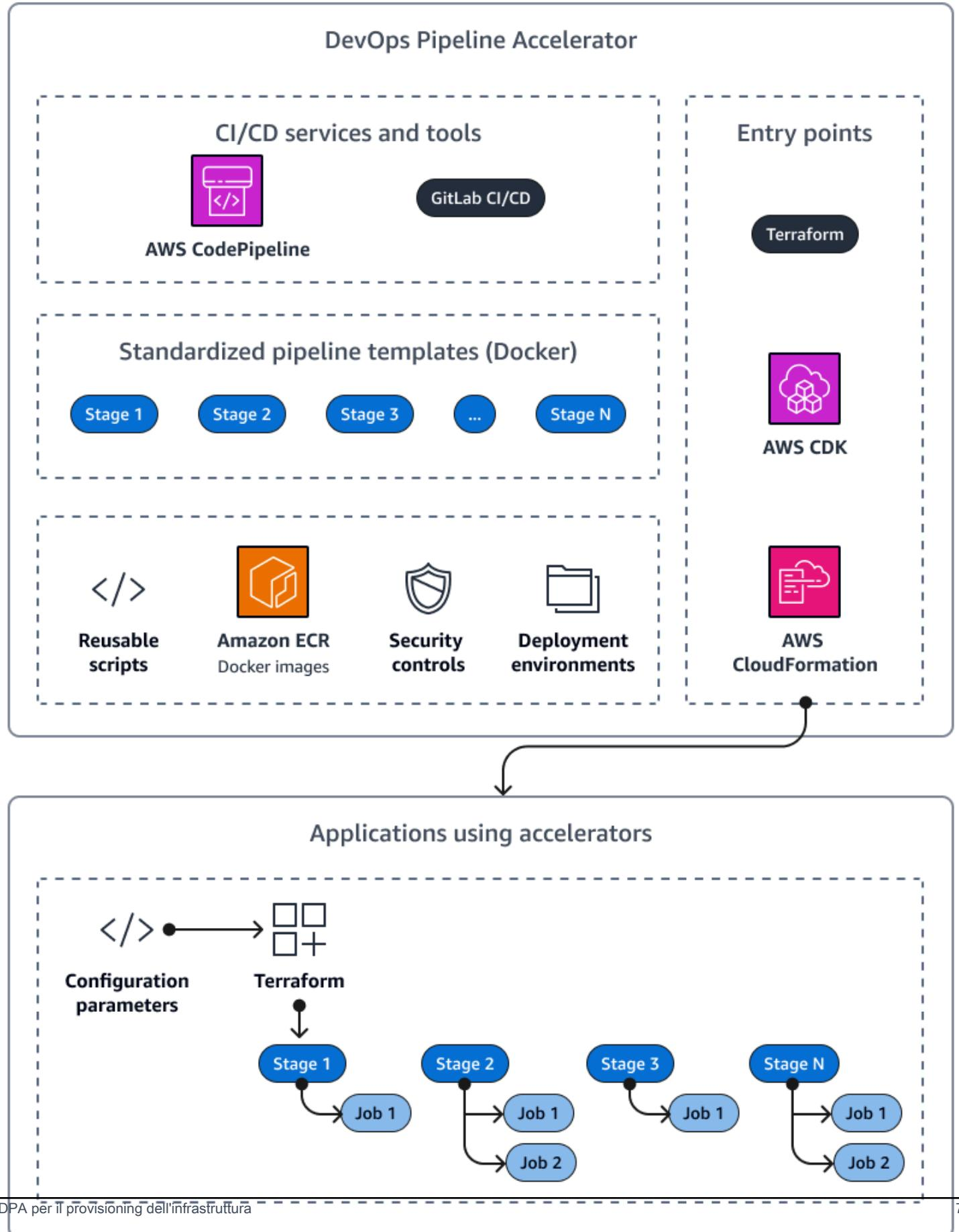
L'immagine seguente mostra una pipeline di riferimento per un'applicazione basata su Terraform, che utilizza il punto di ingresso Terraform. Al termine della fase post-implementazione, il codice entra in una pipeline di rilascio per la distribuzione in ambienti di staging e produzione.
