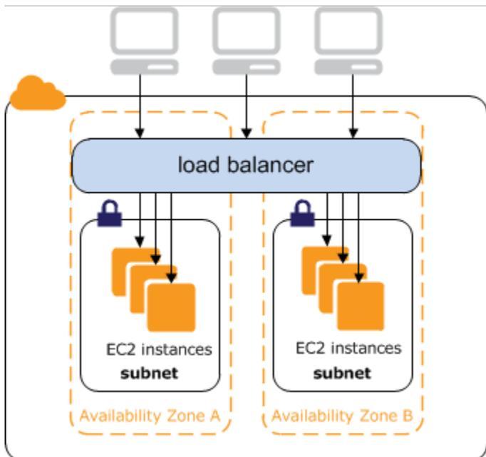
Il nome DNS di un load balancer interno è pubblicamente risolvibile agli indirizzi IP privati dei nodi. Pertanto, i bilanciatori del carico interni possono instradare solo le richieste provenienti da client con accesso al VPC per il load balancer. Per ulteriori informazioni, consulta [bilanciatori del carico interni](#).
