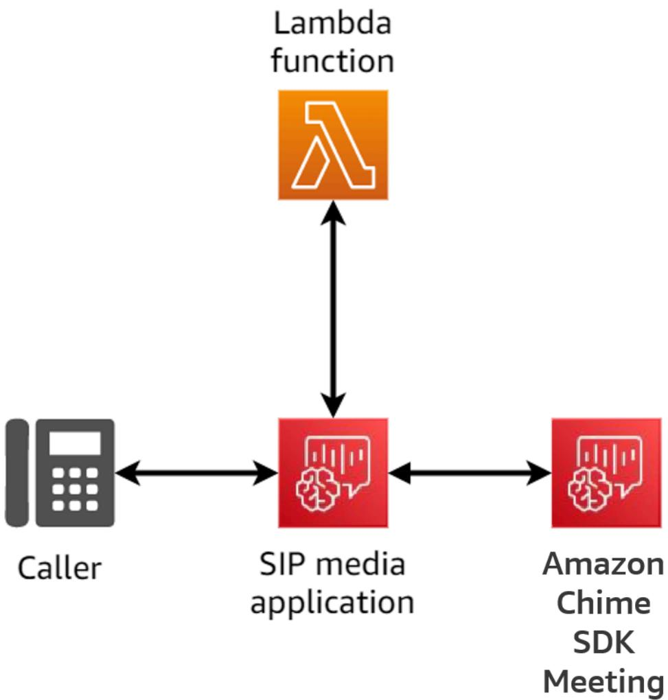
Il diagramma seguente mostra il flusso di una chiamata bridge con più fasi.
