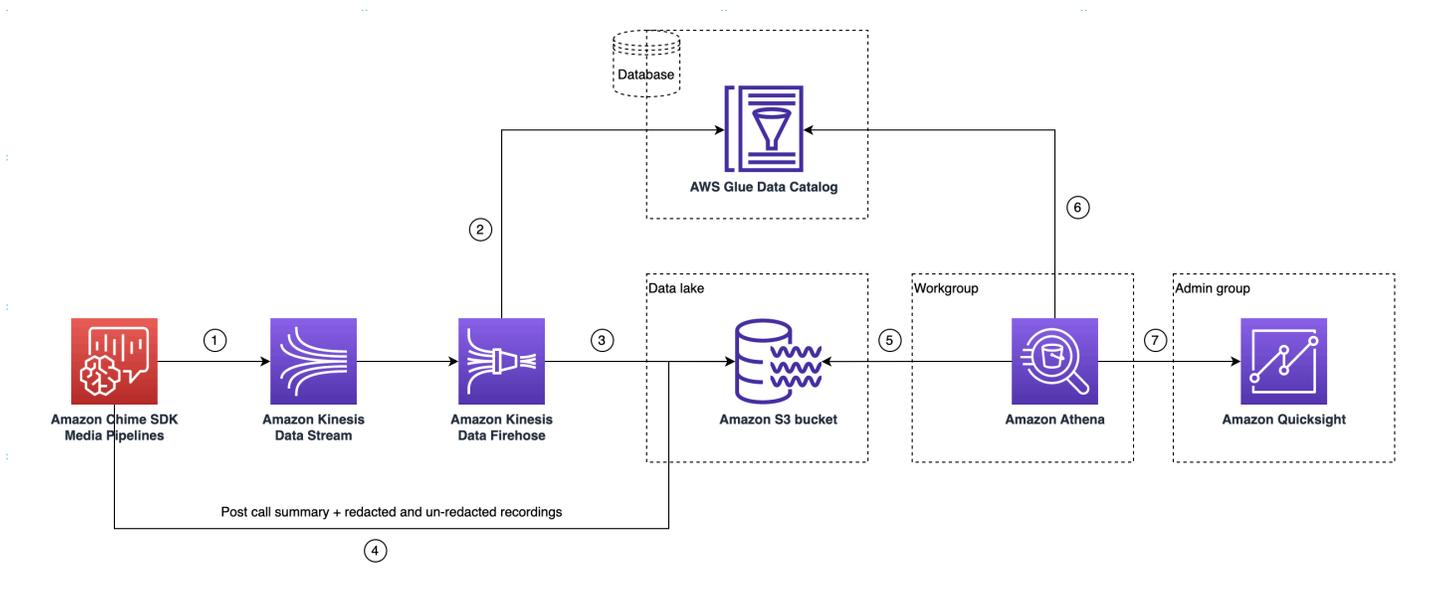
Nel diagramma, dopo aver utilizzato la AWS console per distribuire il CloudFormation modello dal flusso di lavoro di configurazione della pipeline di Media Insights, i seguenti dati fluiscono verso il bucket Amazon S3:
