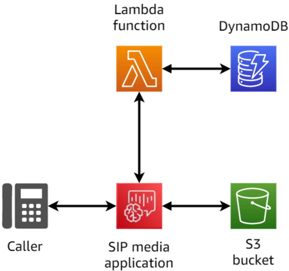
Il diagramma seguente mostra l'architettura di una chiamata a più fasi.
