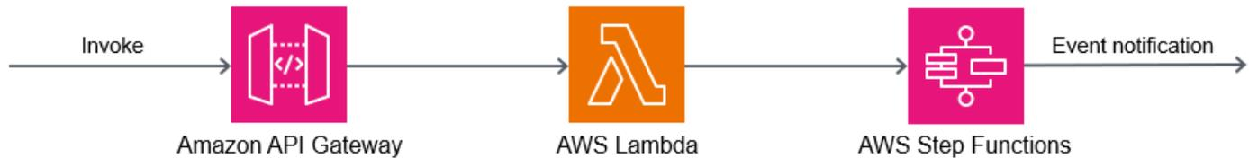
Saat pelanggan memanggil API, fungsi Lambda dipanggil, dan preprocessing terjadi di fungsi Lambda. Fungsi ini memulai alur kerja Step Functions untuk mulai memproses transaksi terdistribusi. Jika preprocessing tidak diperlukan, Anda dapat [memulai alur kerja Step Functions langsung dari API Gateway tanpa menggunakan fungsi](#) Lambda.
