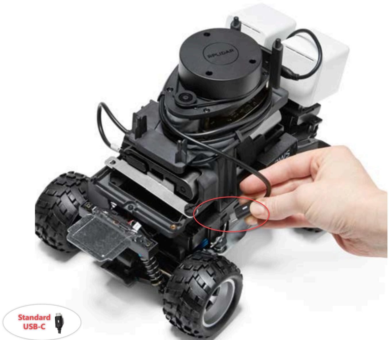
5. Tempatkan shell Evo pada DeepRacer kendaraan AWS Anda dan kencangkan dengan pin untuk menguji kecocokannya. Ketika shell cocok dan sesuai, sensor LiDAR sepenuhnya terlihat melalui potongan di shell, dan Anda memiliki akses ke lubang pin di bagian atas penyangga. Lepaskan shell dan sesuaikan kabel Anda seperlunya.
