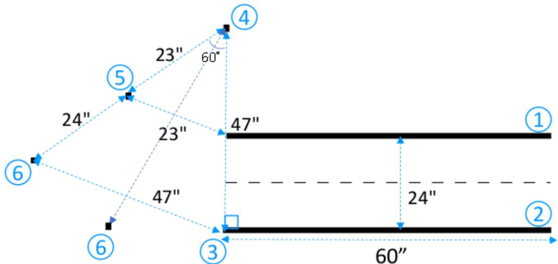
Untuk membuat putaran 60 derajat di sepanjang lintasan, gunakan segitiga sama sisi (3-4-6) untuk menentukan lokasi dari dua titik akhir (5) dan (6) untuk segmen lintasan yang melengkung. Untuk putaran pada sudut yang berbeda, Anda dapat menggunakan busur derajat (atau aplikasi busur derajat) untuk menemukan dua ujung akhir (5) dan (6) dari segmen lintasan yang melengkung. Variasi radius putar dapat diterima selama persyaratan minimum radius putar pada Langkah 2 terpenuhi.
