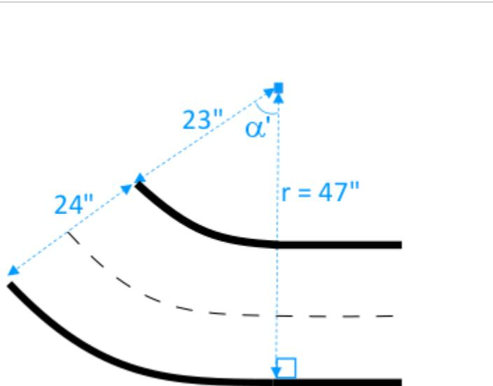
Radius putar minimum ( $r_{\min}$ ) tergantung pada sudut putar lintasan ( $\alpha$ ) di pojok dan harus mematuhi batas berikut:
