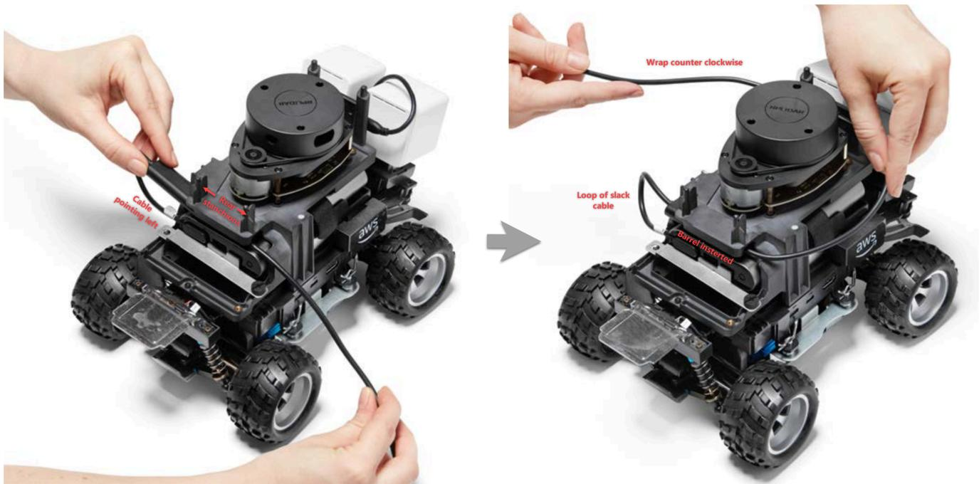
3. Menghadap bagian belakang DeepRacer kendaraan AWS, bungkus kabel berlawanan arah jarum jam di sekitar dasar sensor LiDAR, menggunakan klip kabel untuk mengamankan kabel ke dirinya sendiri untuk memastikan pas.
