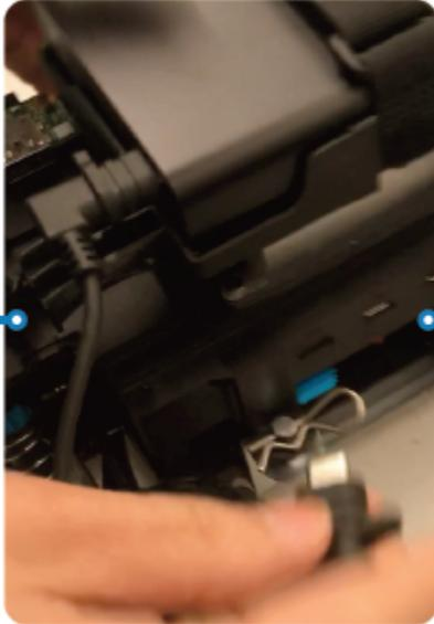
2. Pasang kabel daya AC dan kabel USB-C ke modul adaptor daya komputer (A). Colokkan kabel daya ke stopkontak (C) dan colokkan kabel USB-C pada port daya modul komputer kendaraan (B).
