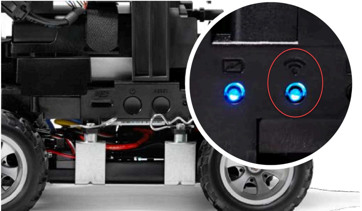
10. Jika LED Wi-Fi berubah merah setelah berkedip, cabut drive USB dari kendaraan dan hubungkan kembali ke komputer Anda. Periksa nama dan kata sandi Wi-Fi yang Anda masukkan dalam file teks untuk salah ketik, salah dalam spasi, casing kalimat yang salah, atau tanda kutip tunggal yang hilang atau disalahgunakan. Perbaiki kesalahan, dan simpan ulang file, serta ulangi langkah 7-9.
