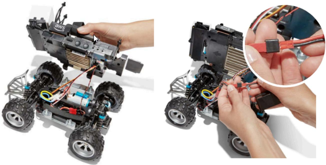
2. Secara opsional, untuk melepaskan modul baterai drive dari kendaraan, putuskan hubungan konektor baterai 2-pin merah dari konektor sistem otomatis drive hitam dan merah dan lepaskan tali Velcro.
