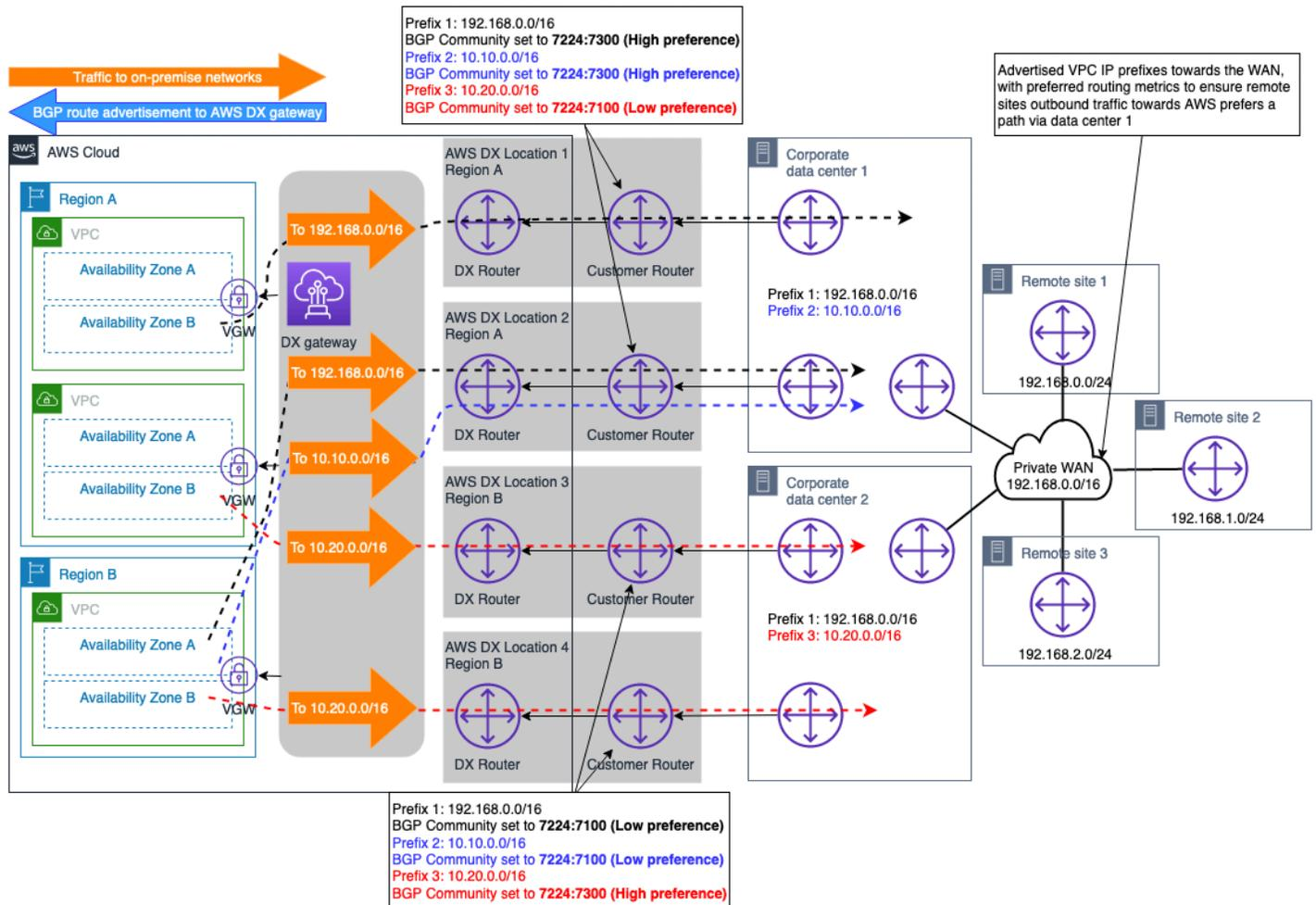
Figure 11 — Exemple de deux sites sur site avec plusieurs connexions DX
