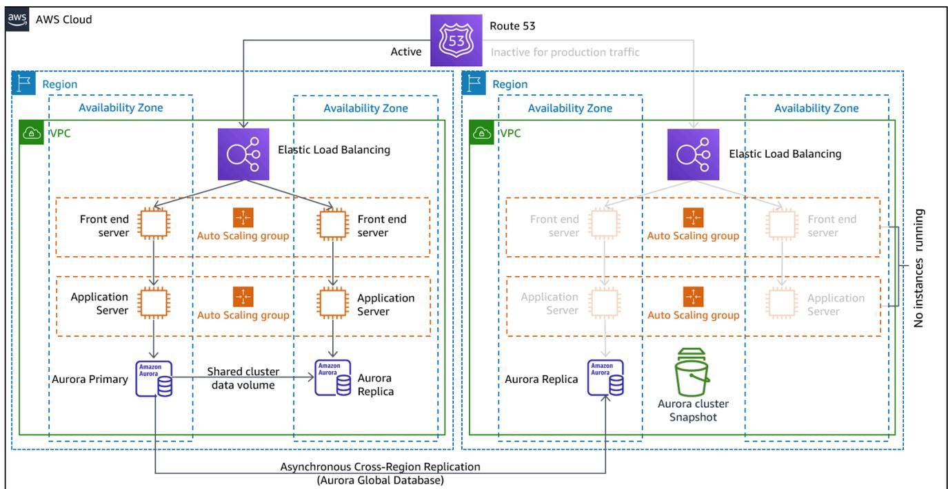
Figure 9 : architecture de la veilleuse
