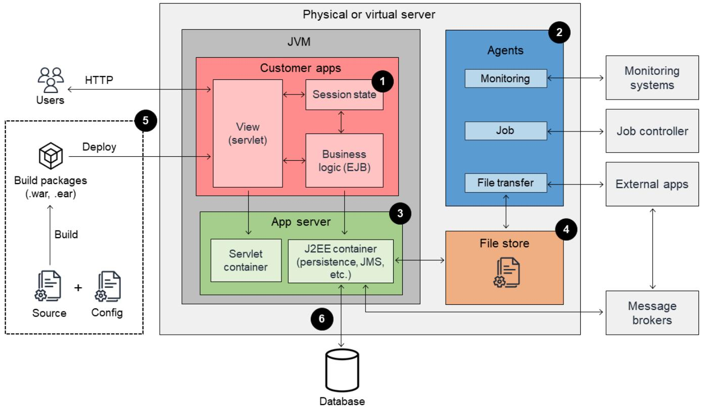
Le schéma suivant montre l'architecture d'une application Java EE conteneurisée.
