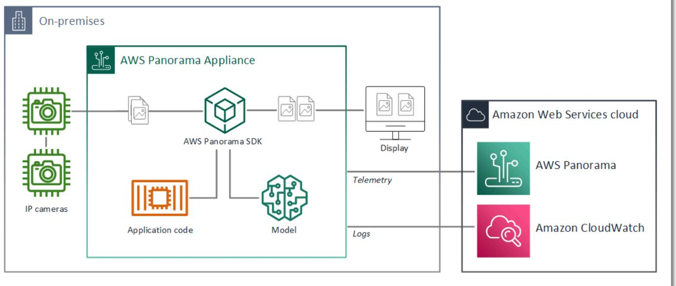
Dans cet exemple, l'application utilise le SDK de l'application AWS Panorama pour obtenir des images vidéo d'une caméra, prétraiter les données vidéo et les envoyer à un modèle de vision par ordinateur qui détecte des objets. L'application affiche le résultat sur un écran HDMI connecté à l'appareil.
