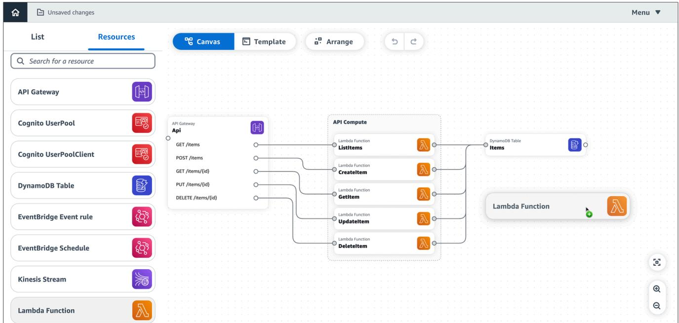
2. Connectez la table DynamoDB à la fonction Lambda. Pour les connecter, cliquez sur le port droit de la carte DynamoDB Table et faites-le glisser sur le port gauche de la carte de fonction Lambda.
