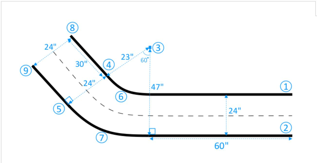
Nous supposons que le deuxième segment rectiligne mesure 30 pouces (76 cm) de long et 24 pouces (61 cm) de large. Vous pouvez ajuster la longueur et la largeur pour adapter le segment à votre espace, à condition de respecter les dimensions requises et d'assurer la cohérence avec les autres segments de la piste.
