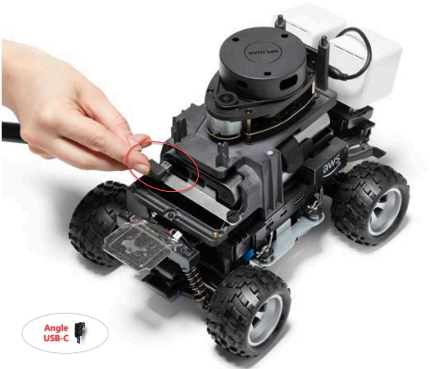
2. En tournant légèrement le véhicule vers la gauche, trouvez l'ouverture menant à l'espace entre le support LiDAR et la batterie de l'ordinateur juste en dessous des montants arrière et faites passer le câble. Arrêtez de faire passer le câble lorsque le canon est inséré dans cet espace. Il doit y avoir une boucle de câble souple à gauche du port USB-C.
