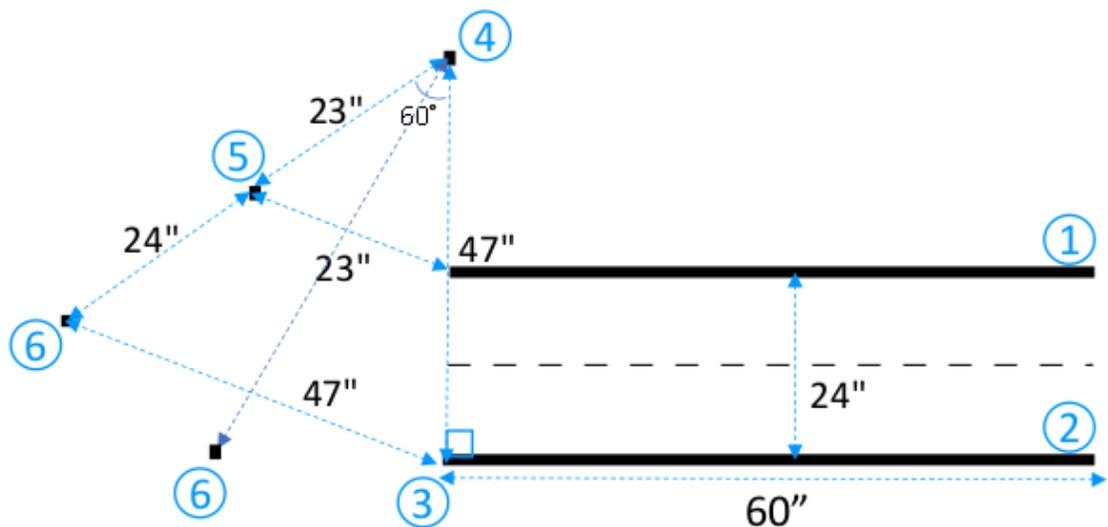
Pour créer un virage à 60 degrés sur la piste, utilisez le triangle équilatéral (3-4-6) pour déterminer l'emplacement des deux extrémités (5) et du segment de piste courbe (6). Pour dessiner des virages d'angles différents, vous pouvez utiliser un compas (ou une application de compas) pour localiser les deux extrémités (5) et (6) du segment de piste courbe. Vous pouvez utiliser d'autres rayons de virages, à condition de respecter le rayon de virage minimal requis indiqué à l'étape 2.
