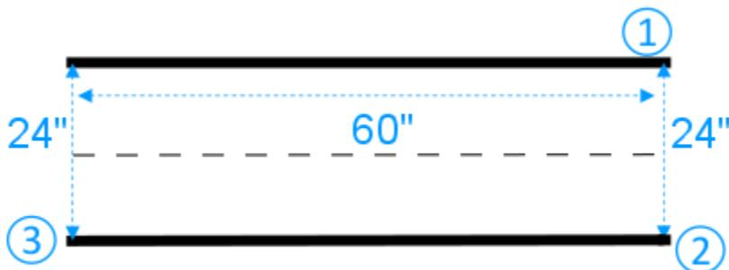
Nous supposons que le segment rectiligne mesure 60 pouces (153 cm) de long et 24 pouces (61 cm) de large. Vous pouvez ajuster la longueur et la largeur pour adapter le segment à votre espace, à condition de respecter les dimensions requises.
