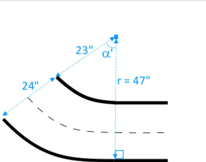
Le rayon de braquage minimal ( $r_{\min}$ ) dépend de l'angle de braquage de la voie ( $\alpha$ ) dans un virage et doit respecter les limites suivantes :
