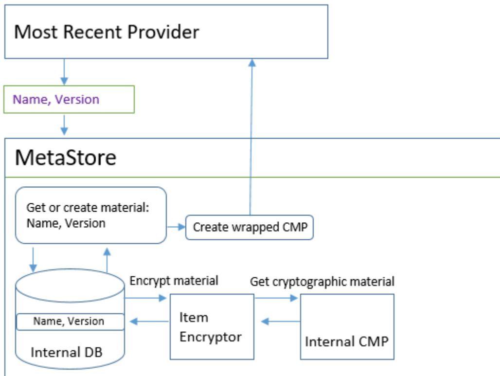
Il MetaStore génère le Wrapped CMPs, puis le stocke (sous forme cryptée) dans une table DynamoDB interne. La clé de partition est le nom du matériel du fournisseur le plus récent ; la clé de tri son numéro de version. Les éléments de la table sont protégés par un client de chiffrement DynamoDB interne, comprenant un crypteur d'éléments et un fournisseur [interne de matériel cryptographique](#) (CMP).
