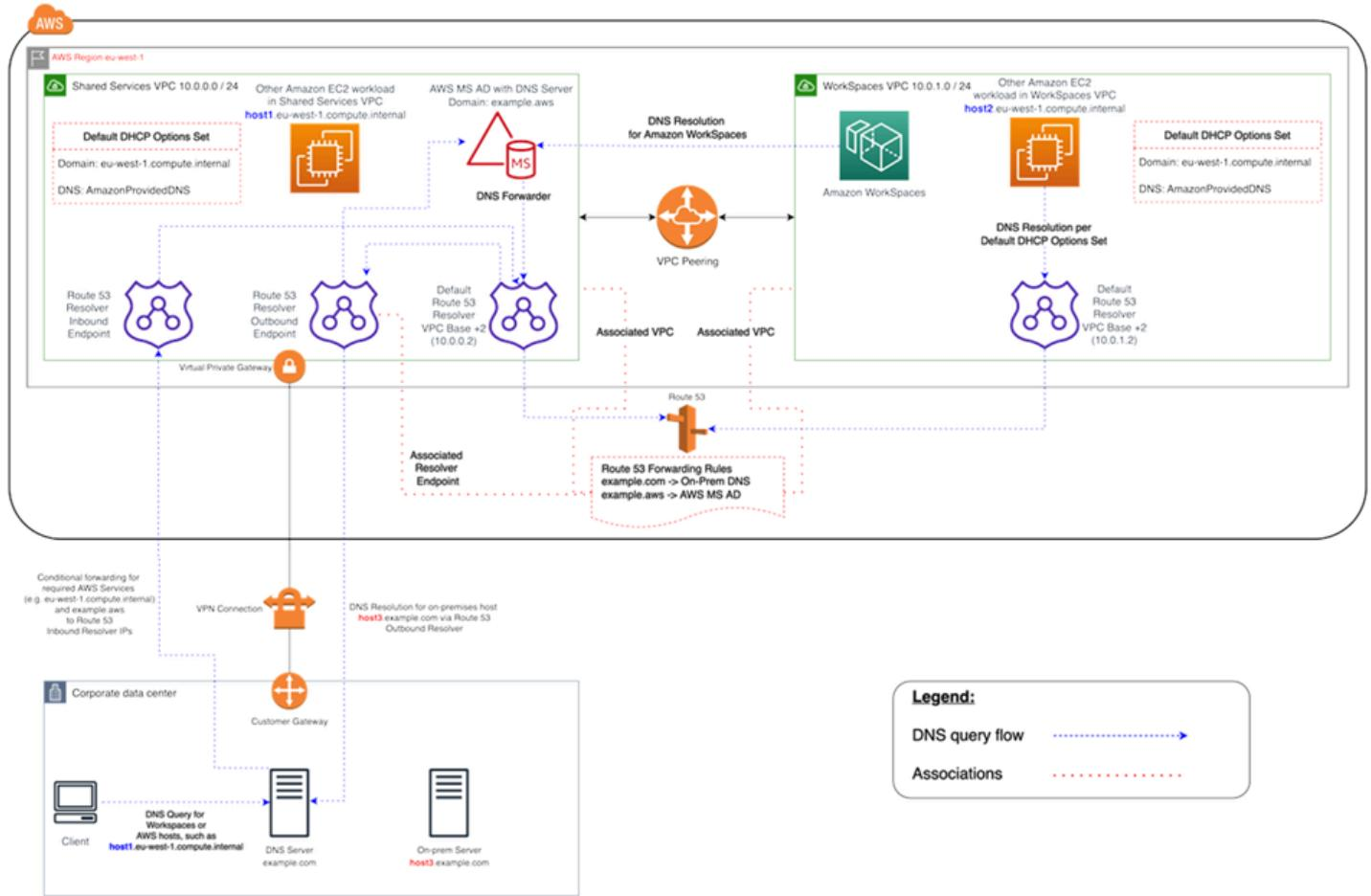
Figura 2: Ejemplo de resolución de WorkSpaces DNS con puntos finales de Route 53
