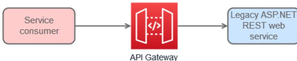
Cuando el proxy API Gateway esté instalado, podrá crear e implementar el servicio modernizado AWS mediante Amazon ECS, por ejemplo, para lograr un servicio altamente escalable y disponible. Cuando se hayan creado y probado el proxy y el servicio recién modernizado, puede volver a configurar el punto final de API Gateway para que apunte a la API REST modernizada para su implementación.
