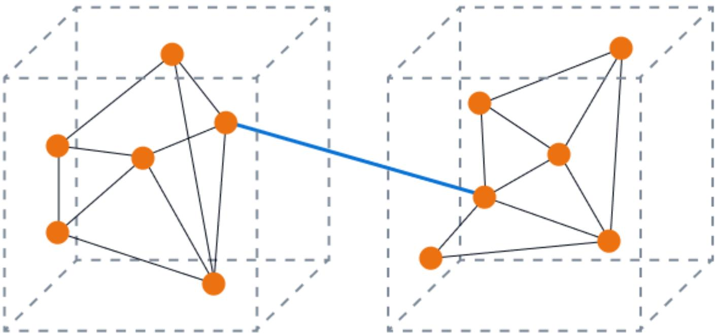
La siguiente imagen muestra un alto acoplamiento con baja cohesión. Los componentes de la base de datos están desconectados y es muy probable que los cambios afecten a otros componentes.
