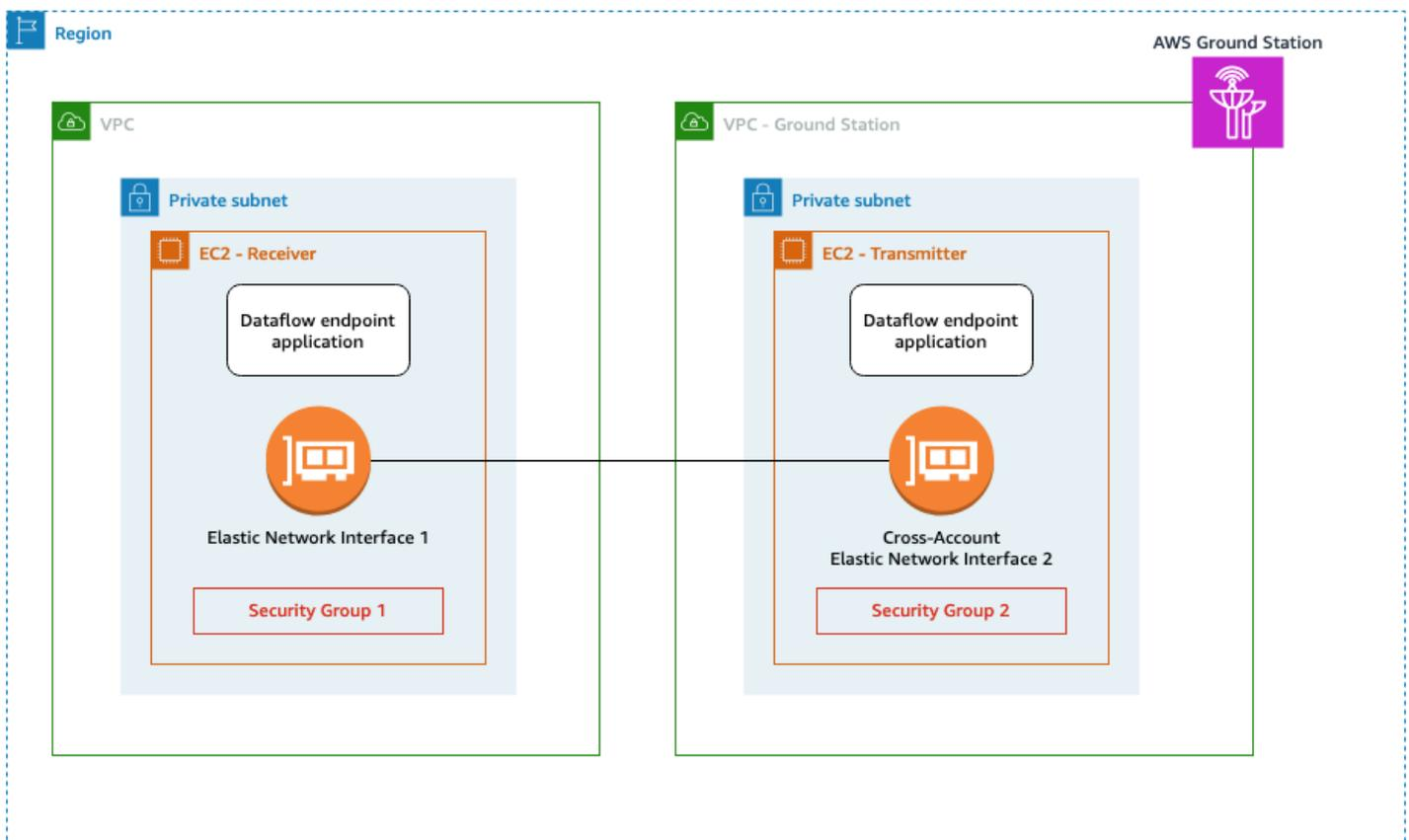
Los datos de su satélite se proporcionan a una instancia de aplicación de punto final de flujo de datos próxima a la antena. Luego, los datos se envían a través de [Amazon EC2 Elastic Network](#)
