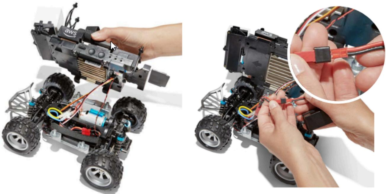
2. Encienda el tren de transmisión del vehículo moviendo el interruptor a la posición «on». Preste atención al sonido indicador (dos pitidos cortos) que confirma que el vehículo tiene carga. Si el vehículo se enciende correctamente, vaya al paso 4.
