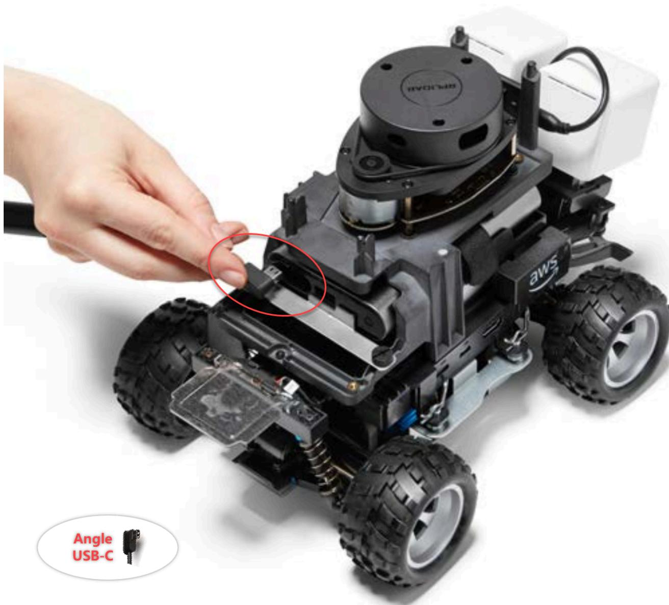
2. Gire apenas el vehículo hacia la izquierda, localice la abertura al espacio entre el soporte LiDAR y la batería de cómputo justo debajo de los montantes traseros y pase el cable. Deje de tirar del cable a través cuando el barril se haya insertado en este espacio. Debe quedar un bucle de cable flojo a la izquierda del puerto USB-C.
