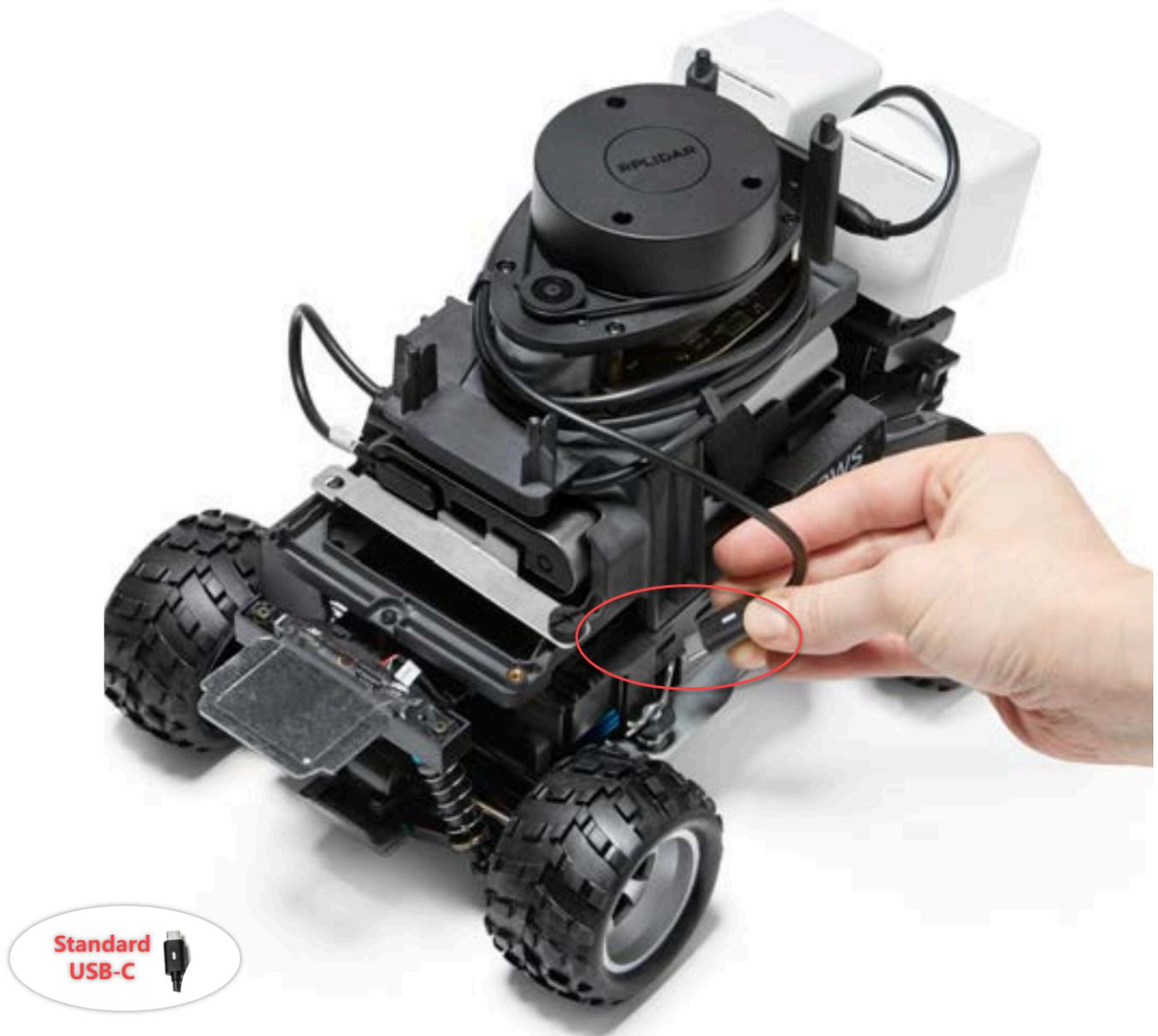
5. Coloque la carcasa Evo en su DeepRacer vehículo de AWS y fijela con alfileres para comprobar su ajuste. Cuando la carcasa encaja correctamente, el sensor LiDAR es totalmente visible a través del recorte de la carcasa y tiene acceso a los orificios de los pasadores en la parte superior de los montantes. Retire la carcasa y ajuste el cable según sea necesario.
