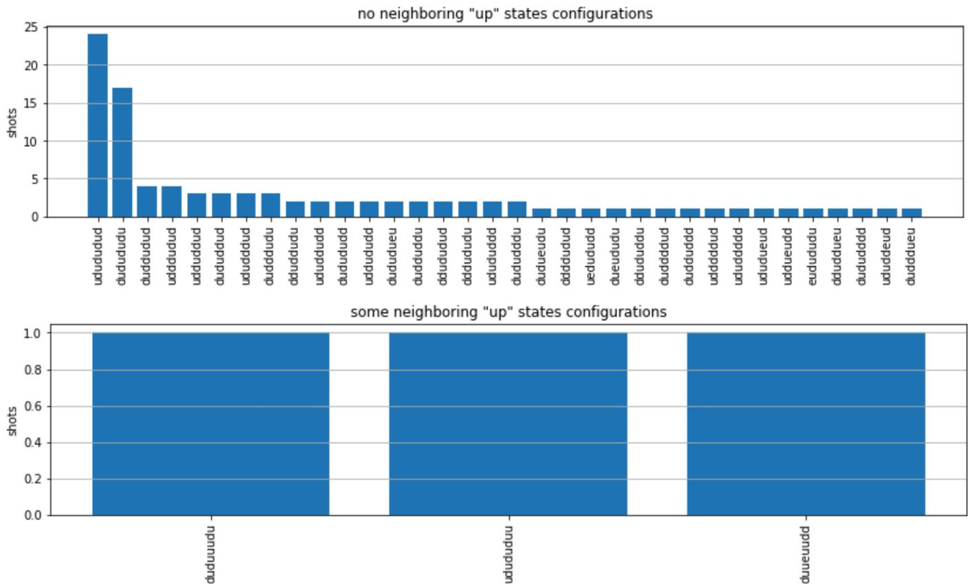
Tenga en cuenta que una pequeña fracción de las tomas tiene sitios vacíos (marcados con una «e»). Esto se debe a que la Aquila QPU presenta imperfecciones en la preparación de un 1-2% por átomo. Además, los resultados coinciden con la simulación dentro de la fluctuación estadística esperada debido al reducido número de disparos.
