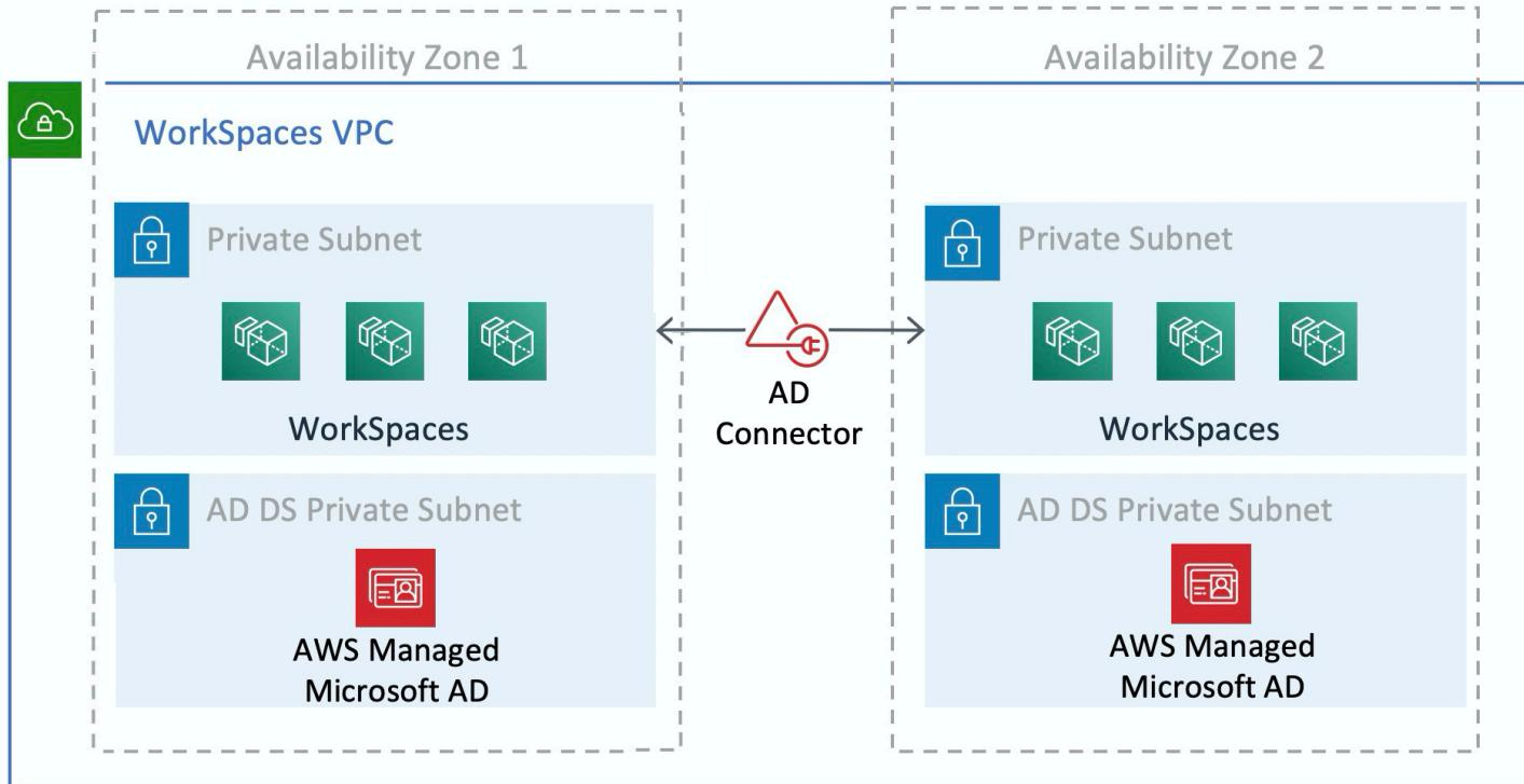
Abbildung 13: AD-DS-Netzwerk trennung
