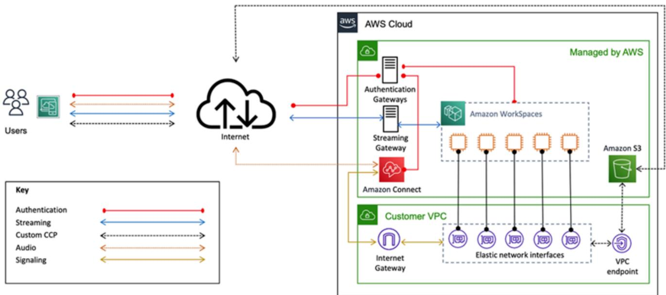
Abbildung 26 – Amazon Connect und WorkSpaces Architekturdiagramm
