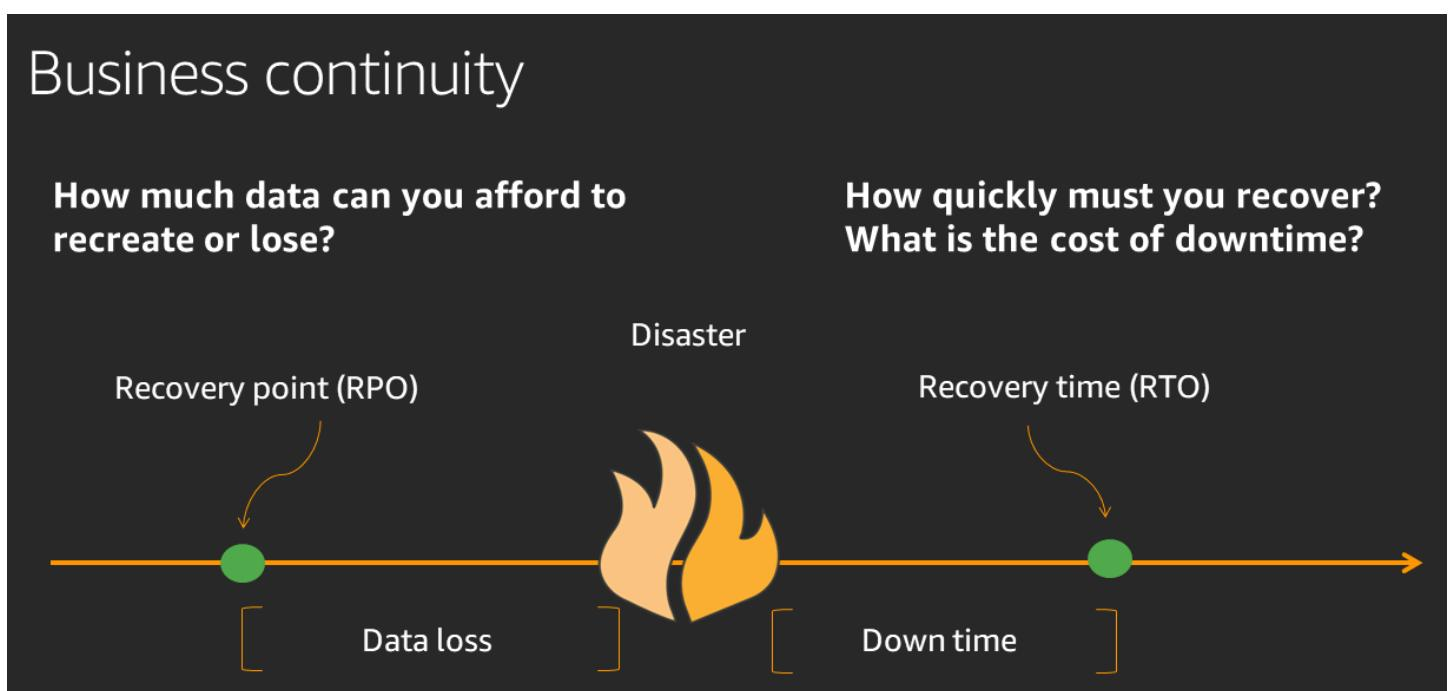
Die Beziehung von RPO (Recovery Point Objective), RTO (Recovery Time Objective) und dem Notfallereignis.
