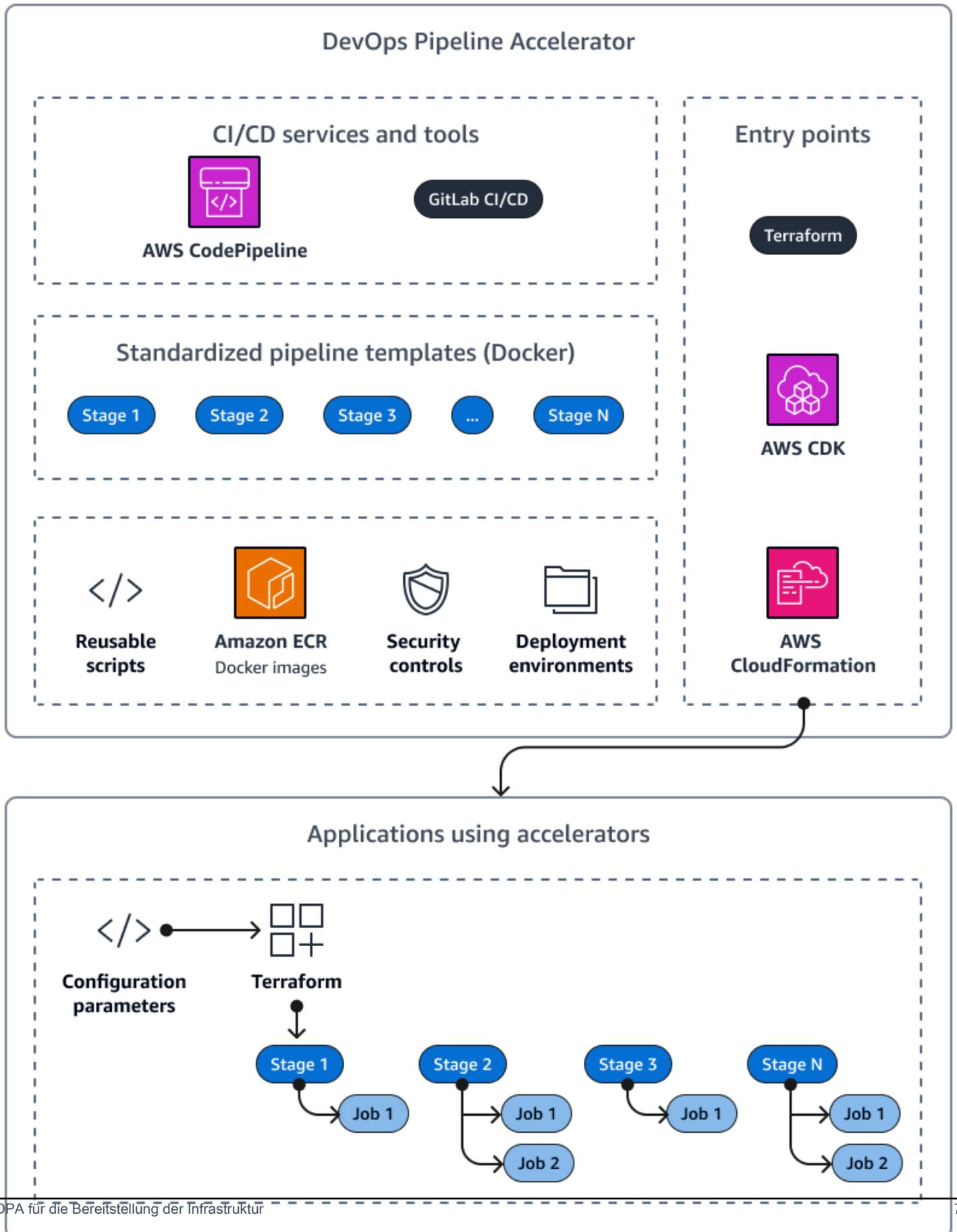
Die folgende Abbildung zeigt eine Referenzpipeline für eine Terraform-basierte Anwendung, die den Terraform-Einstiegspunkt nutzt. Am Ende der Phase nach der Bereitstellung wird der Code in eine Release-Pipeline für die Bereitstellung in Staging- und Produktionsumgebungen aufgenommen.
