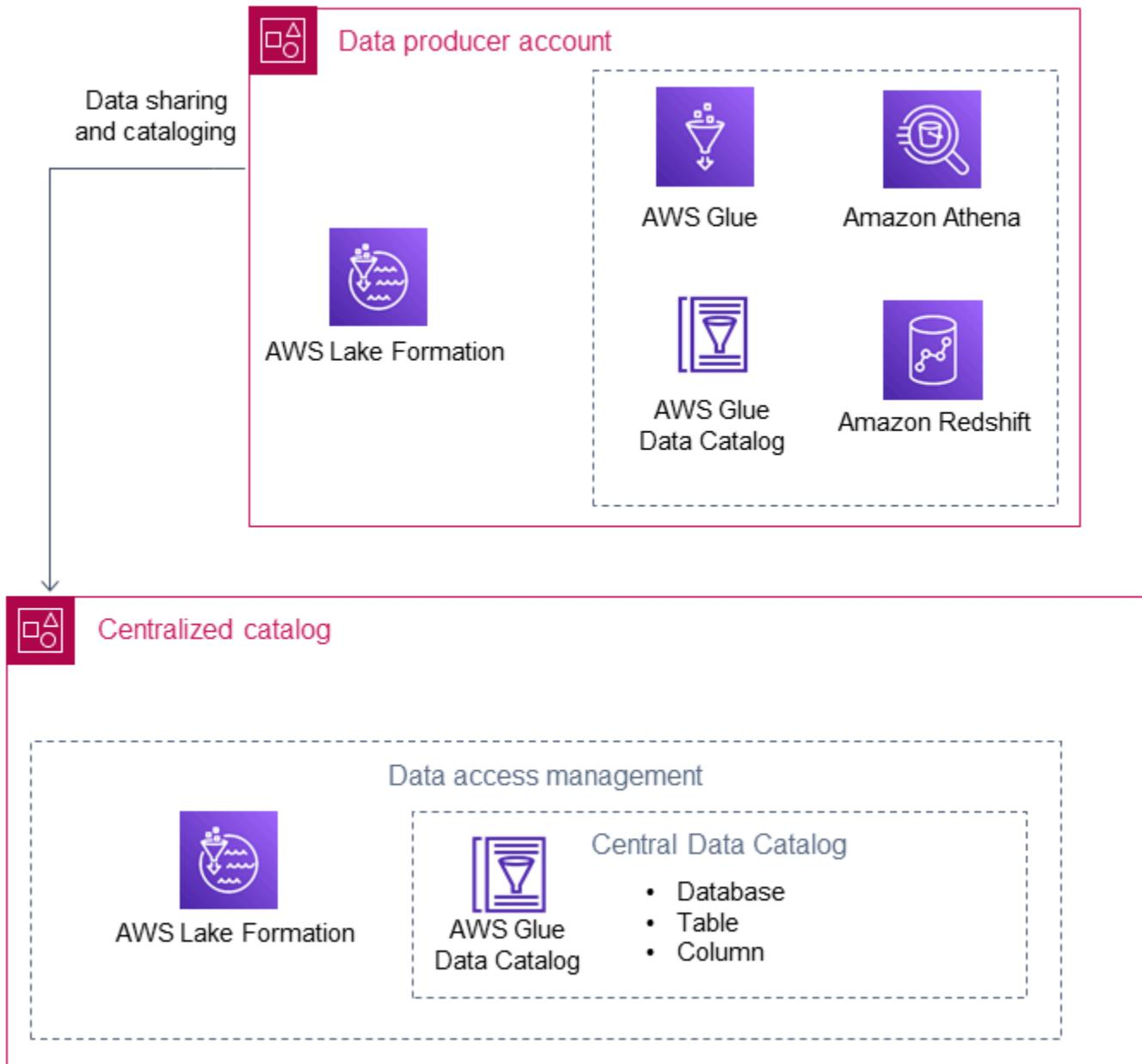
Jeder Datenproduzent verfügt über einen eigenen Datenkatalog AWS-Konto, der von seinem internen Datenprozess verwaltet wird. AWS Lake Formation Datenproduzenten gewähren dem zentralisierten Katalog selektive Berechtigungen für ihre Daten, was bedeutet, dass Lake Formation im zentralisierten Katalogkonto auf Daten zugreifen kann, die der Datenproduzent teilen möchte.
