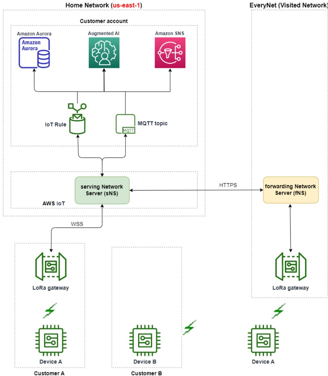
AWS IoT Core for LoRaWAN verwendet eine Roaming-Hub-Funktionalität gemäß der technischen Empfehlung zum [LoRaWAN Roaming Hub der LoRa Alliance](#). Der Roaming-Hub bietet einen
