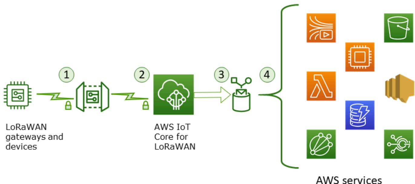
1. Das LoRaWAN-Funkgerät verschlüsselt seine Binärnachrichten im AES128-CTR-Modus, bevor es sie überträgt.
